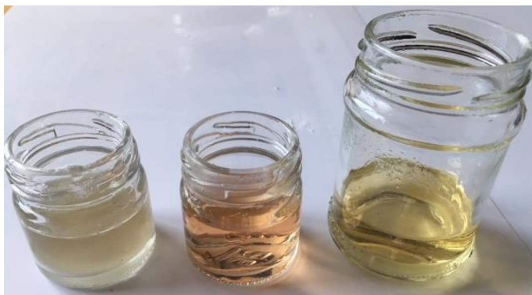
Figura 2. I 3 vasetti contenenti soluzione basica di bicarbonato di sodio (a sinistra), acida di aceto (centro) e basica per idrolisi dell'acetato di sodio (a destra), a seguito dell'utilizzo dell'indicatore.
