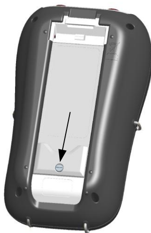
Image 5.14: Fermeture du couvercle du compartiment des piles
