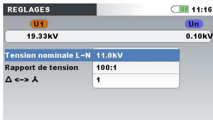
Image 4: Exemple du ratio de tension pour transformateur 11kV/110kV
