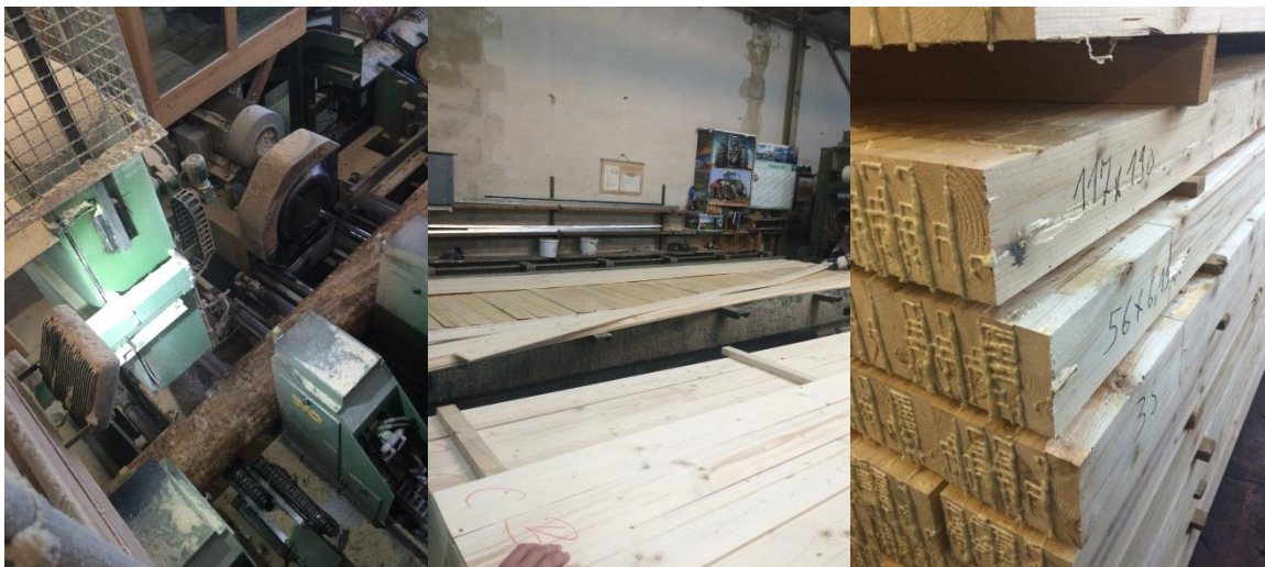
Figur 3. Bandsågen in action, tre-skikts panel för möbler mm, limträ, ej fingerskarvat (ger högre utbyte).
