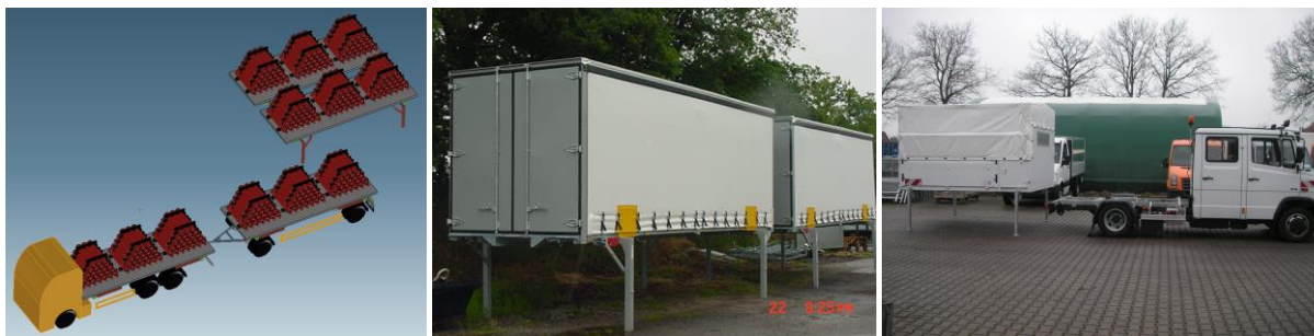
Figur 6: Transportsystem för trycksatt gas i tankar med WAB-systemet: gastransportfordon med 150 cylindrar med 80 liters volym och 220 bar (till vänster); växelflaksystem (i mitten); lätt lastbil med växelflak (till höger). Källa: Güssing Energy Technologies GmbH, Schoon Fahrzeugsysteme
