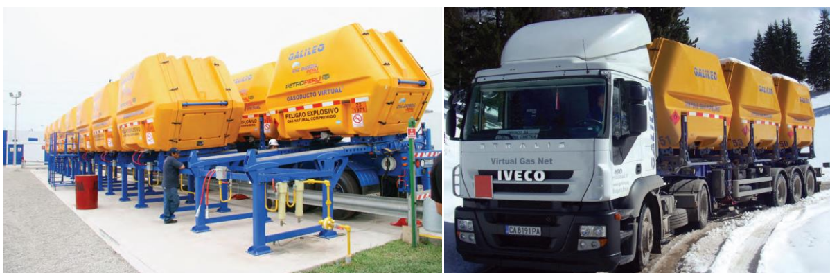
Figur 7: Transportsystem för trycksatt gas – Galileo-systemet ”virtuell rörledning”. Källa: Galileo SA
