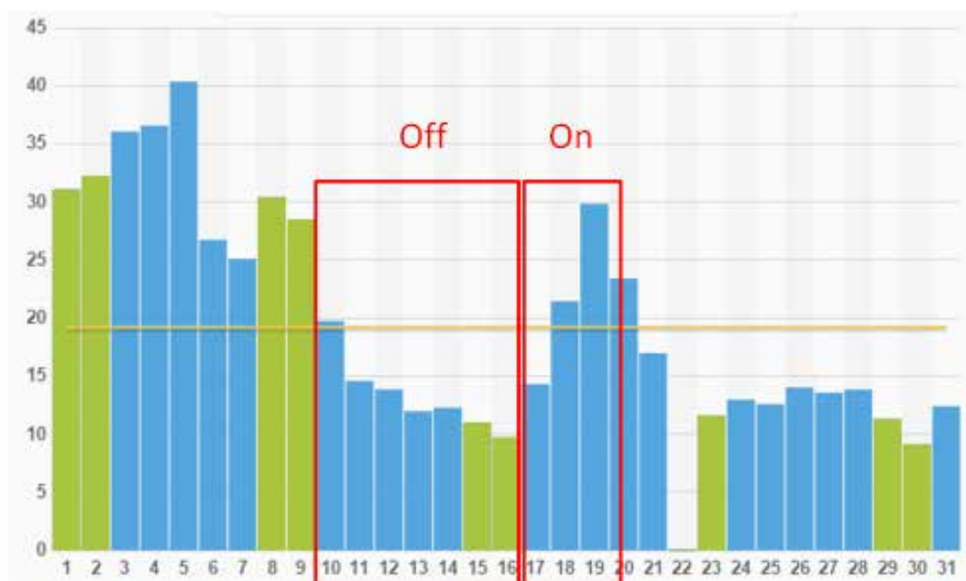
Figur . Elanvändningen dag för dag under mars 2014. De elektriska värmeelementen stängdes av och användes sedan igen under ett experiment (rutorna). Efter experimentet stängde kontoret av de elektriska värmeelementen permanent (graf från MitNRGI).
