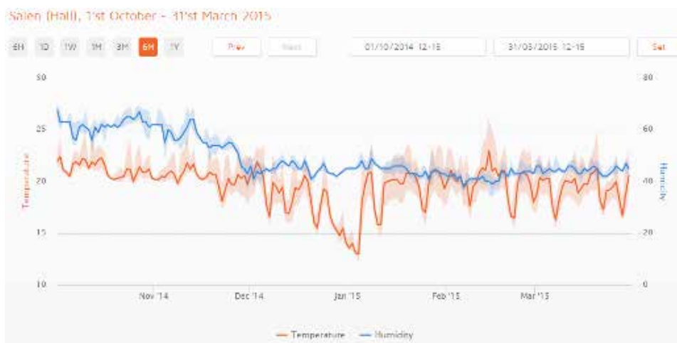
Figur 1. Temperaturen (röd) och fuktigheten (blå) dokumenterades under tre månader. Temperatursänkningen infördes runt 14 december i grafen. Som ett resultat sjönk inomhustemperaturen och uppvärmningskostnaderna minskade därmed (graf från Sensorist)
