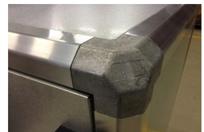
BOXFAN är uppbyggd av ett ramverk av naturanodiserade aluminiumprofiler med hörn i klarlackad gjuten aluminium. Paneler i aluzink 185.
