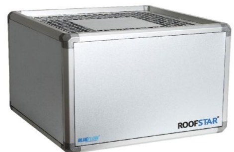
Fläkthöljet är som standard tillverkat i aluzink 185 men kan även levereras i svart lackerad plåt (50 my). Höljet är isolerat med 30 mm alternativt 50 mm Cleantec beroende på fläktstorlek. Utblåsriktning uppåt.
