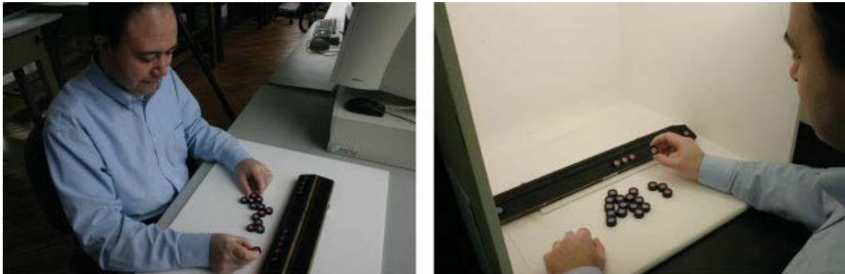
Figur 1: Farnsworth-Munsell testprov i dagsljus (till vänster) och en vy in i apparaten som användes under studien (till höger).
