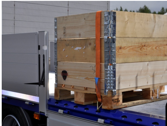
Uskurna hål för surring. c-c ca 150mm.
