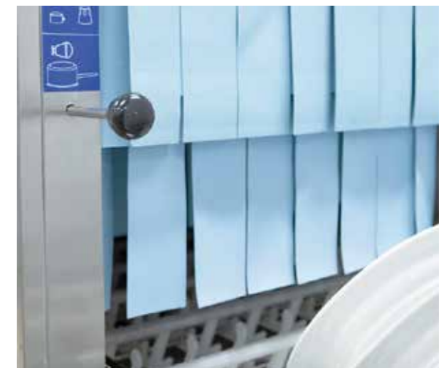
Ställbart spoltryck Med ett reglage ökas spoltrycket i de undre diskarmarna. Detta ger en kraftigare mekanisk bearbetning av diskgodset och maskinen kan användas för grovdisk. (option)
