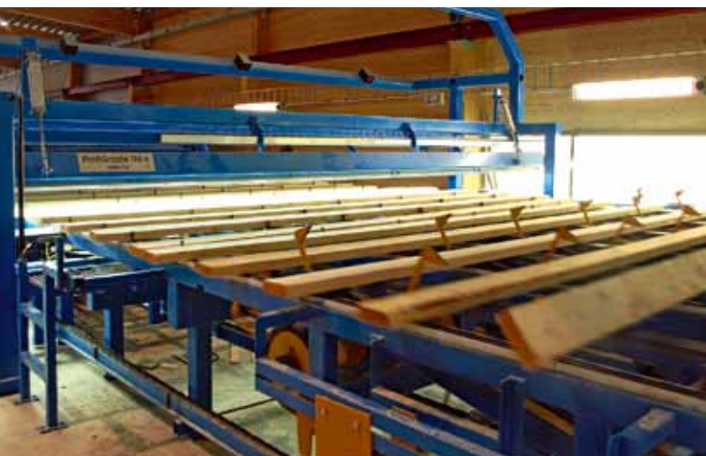
Patentierter Brettwender: Zwischen den beiden Scannereinheiten werden die Bretter gewendet, damit beide Oberflächen überprüft werden können
