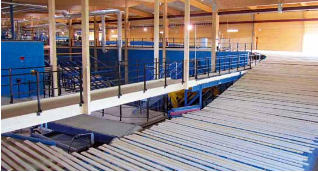
Bis zu 200 Stück pro Minute werden von der CGV Gunnarssons-Anlage in Norrköping/SE verarbeitet
