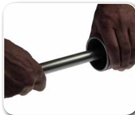
Figur 5: Avgrading av røret
