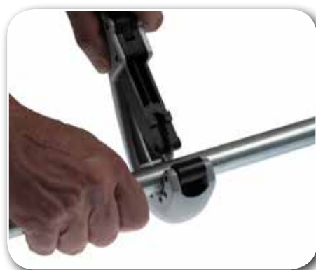
Figur 4: Kapping av røret
