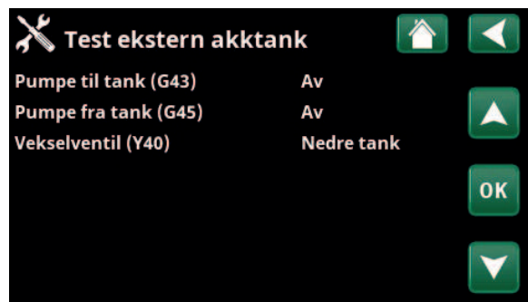
Meny «Avansert/Service/Funksjonstest/Ekstern buffertank».
