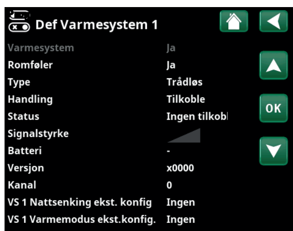
Meny «Avansert/Definere/Varmesystem/Varmesystem 1». Trådløs romføler er valgt.
