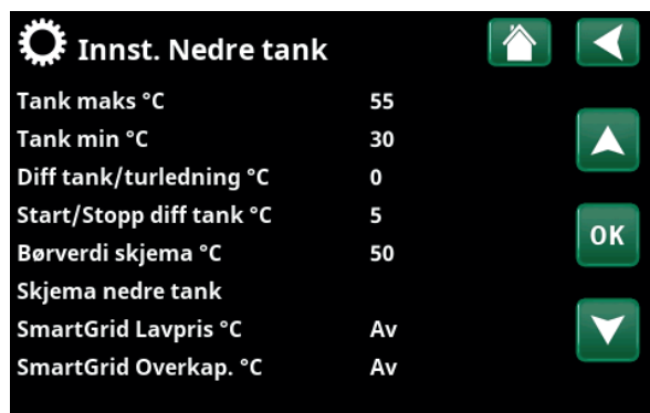
Meny «Avansert/Innstillinger/Nedre tank».
