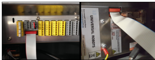
18.1: Ligação do cabo tipo fita
