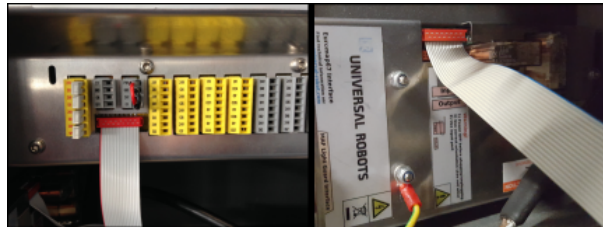
CF :18.1:リボンケーブルの接続
