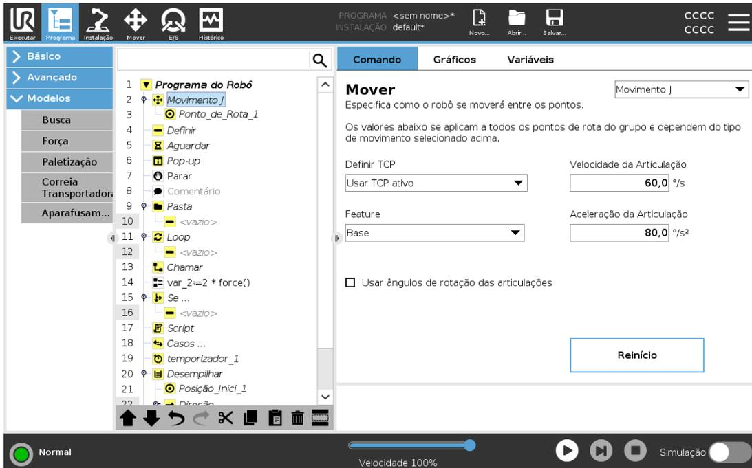
O comando **Mover** controla o movimento do robô através dos pontos de rota (waypoints) subjacentes. Os Waypoints têm de estar sob um comando Mover. O comando Mover define a aceleração e a velocidade em que o braço do robô se moverá entre esses pontos de rota.
