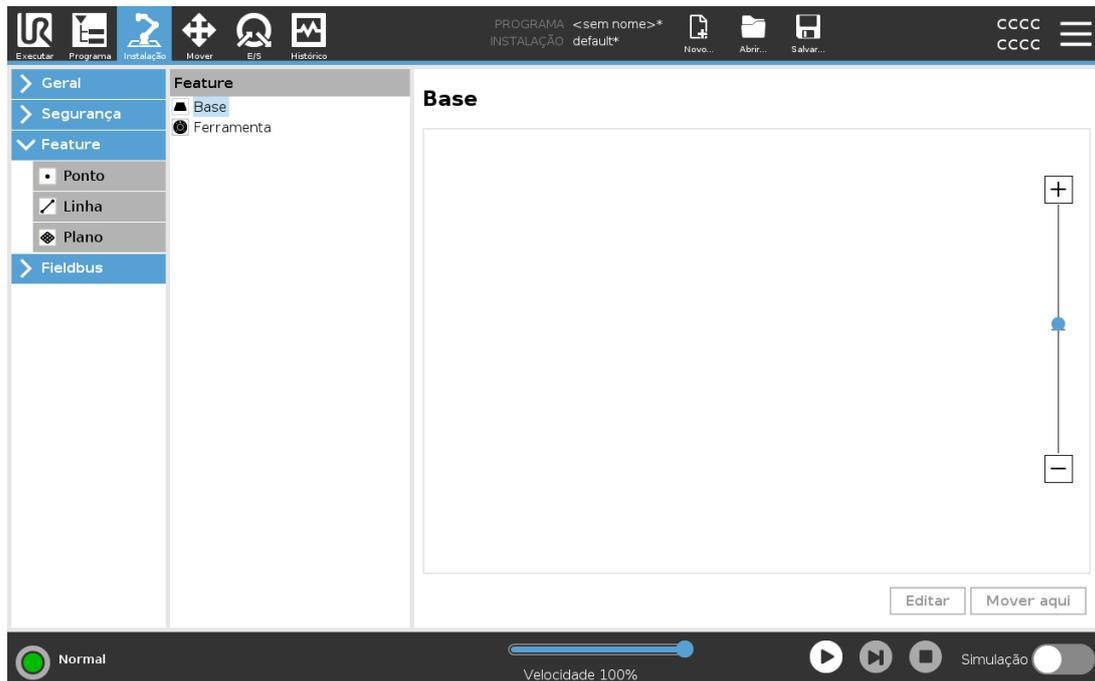
Uma **Funcionalidade** representa um objecto definido por uma pose de seis dimensões (posição e orientação) em relação à base do robô. Pode atribuir um nome à funcionalidade para referência futura.
