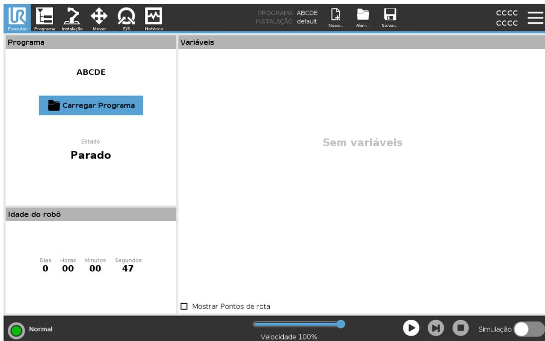
O separador **Executar** permite-lhe simplesmente operar o braço do robô e a caixa de controlo, utilizando o menor número possível de botões e opções. Para transformar o robô numa ferramenta que possa executar exclusivamente programas pré-escritos, é possível combinar a operação simples de parte de programação do PolyScope com a proteção por palavra-passe (ver [30.3. Configurações na página 281](#))
