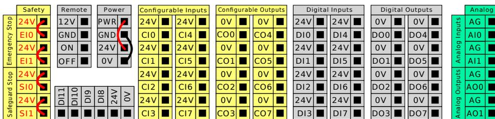
Pode utilizar o bloco horizontal de Entradas Digitais (DI8-DI11), ilustrado abaixo, para codificação em quadratura do Rastreamento de Transportadoras (ver 5.4.1. [As especificações comuns para todas as E/S digitais na página oposta](#)) para estes tipos de entrada.
