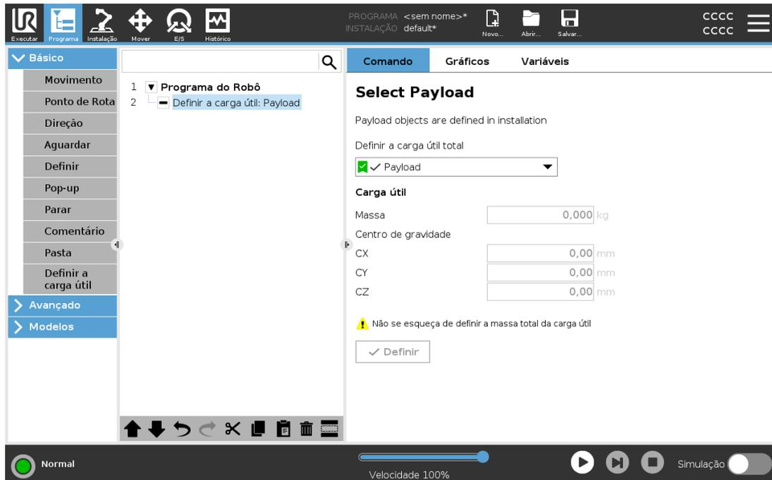
Utilize o comando **Definir Carga Útil** para definir a carga útil do braço do robô. Pode ajustar o peso da carga útil para evitar que o robô realize uma parada de proteção, quando o peso na ferramenta for diferente do peso esperado para a carga útil.
