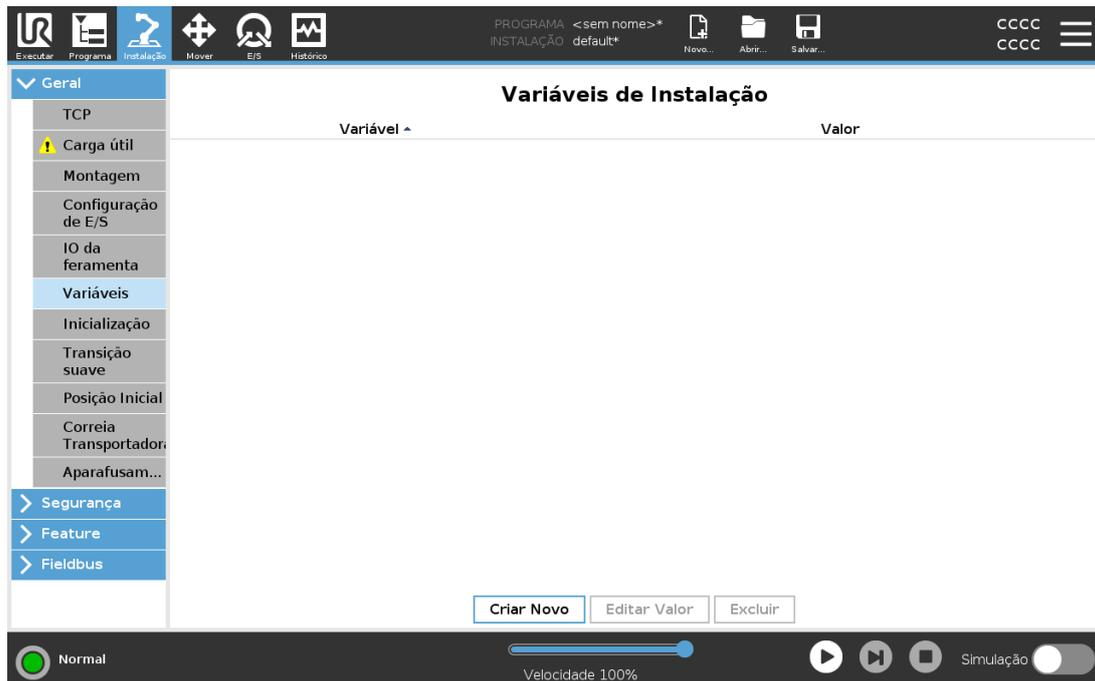
As variáveis criadas no ecrã de **Variáveis de Instalação** chamam-se variáveis de instalação e são utilizadas como variáveis normais do programa. As variáveis de instalação são distintas porque mantêm o seu valor mesmo que um programa pare e depois recomeça, e quando o braço do robô e/ou a Caixa de Controlo são desligados e ligados novamente.
