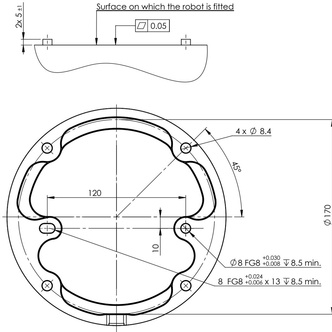
**5.1:** *Furos na montagem do robô. Utilize quatro parafusos M8 . Todas as medidas estão em mm.*
