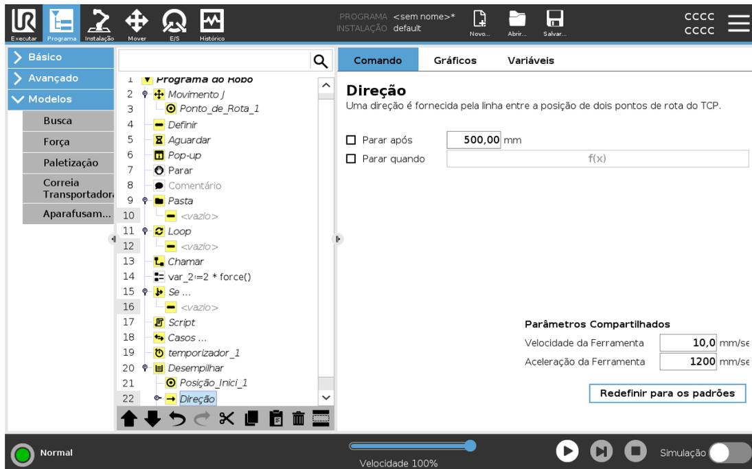
A direção, dada pelas posições *B* a *C*, é calculada como sendo a diferença de posição em relação ao TCP de *B* para o TCP de *C*.
