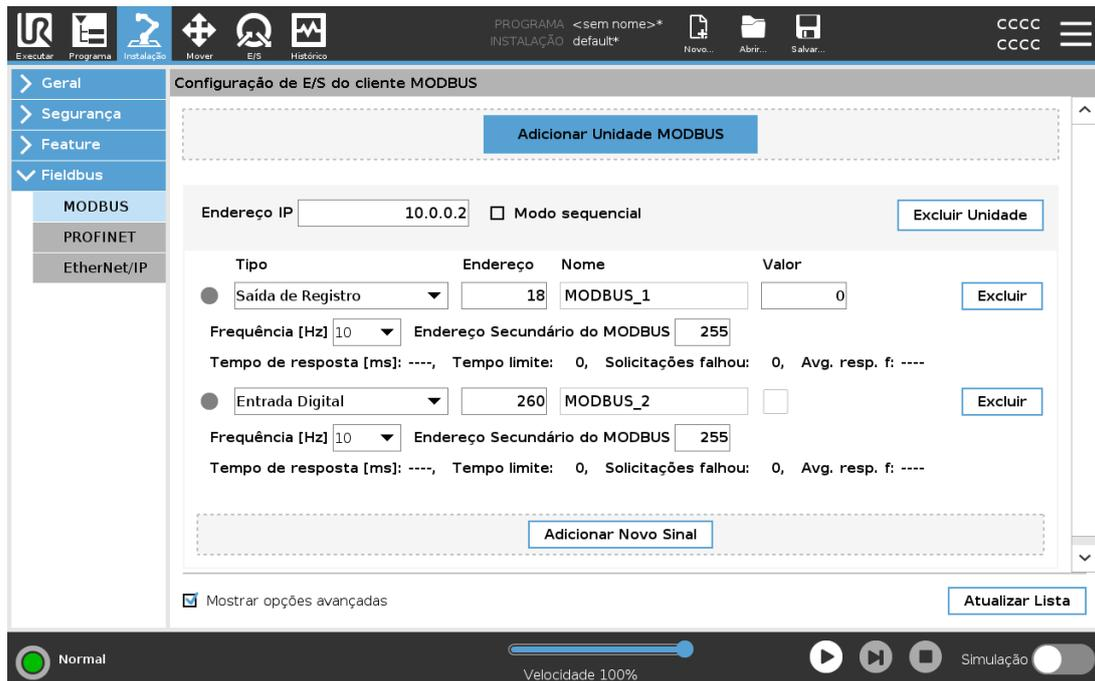
Aqui, podemos definir os sinais do cliente (master) MODBUS. Conexões com servidores (ou escravos) MODBUS nos endereços IP especificados podem ser criadas com sinais de entrada/saída (registros ou digitais). Cada sinal tem um nome exclusivo para que possa ser usado em programas.
