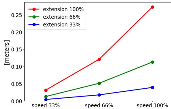
Distância de paragem em metros para uma carga útil máxima de 12,5kg
