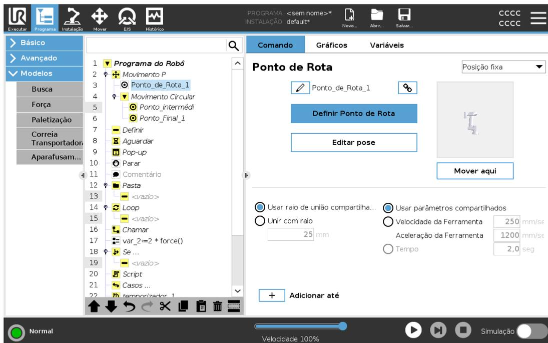
Um ponto no caminho do robô. Os Waypoints são a parte mais central de um programa de robôs, dizendo ao braço do robô onde ele deve estar. Um ponto de rota de posição fixa é ensinado movendo fisicamente o braço do robô para a posição.
