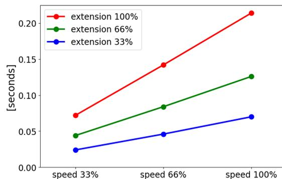
Tempo de paragem em segundos para uma carga útil máxima de 12,5kg
