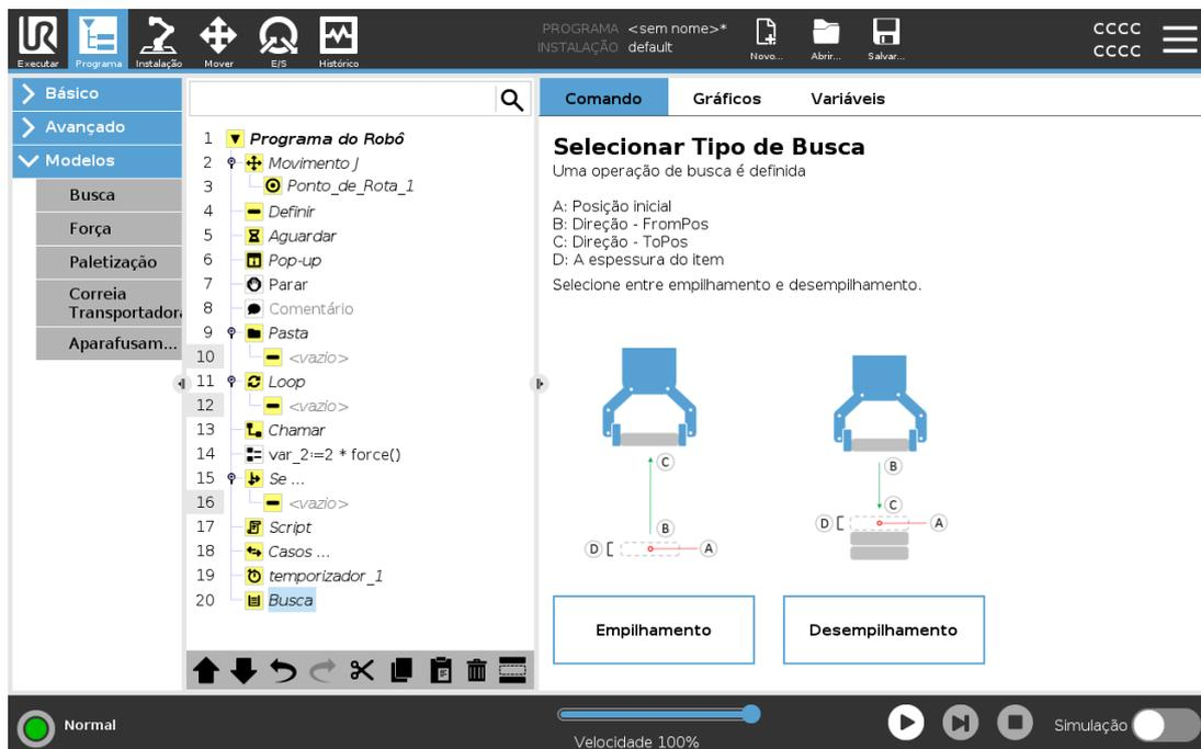
Ao empilhar, o braço do robô move-se para o ponto *A*, e depois move-se na direção *oposta* para procurar a próxima posição de empilhamento. Quando a próxima posição de pilha é encontrada, o robô lembra-se da mesma e executa a sequência especial.
