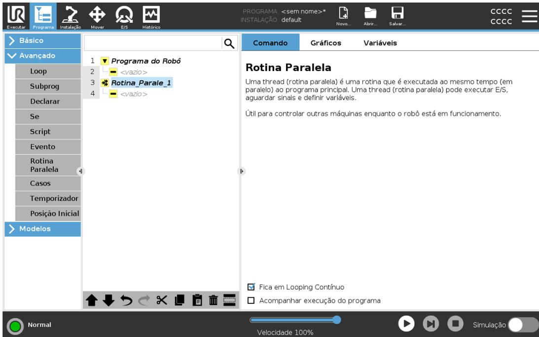
Um thread é um processo paralelo ao programa do robô. Um thread pode ser usado para controlar uma máquina externa de forma independente do braço do robô. Um thread pode se comunicar com o programa do robô com variáveis e sinais de saída.
