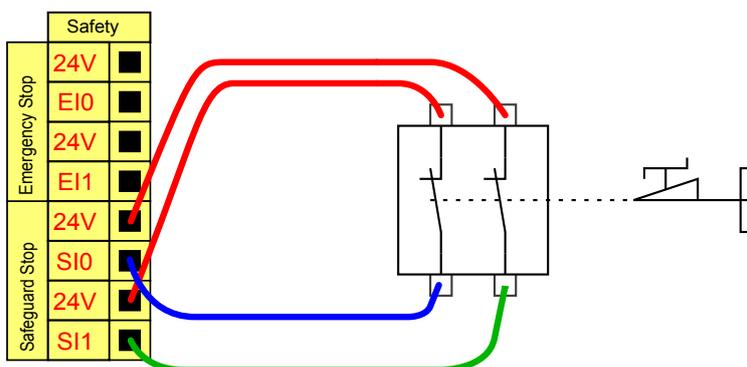
Essa configuração é destinada somente à aplicação em que o operador não pode passar a porta e fechá-la atrás de si. A E/S configurável é usada para configurar um botão de reset do lado de fora da porta, para reativar o movimento do robô.
