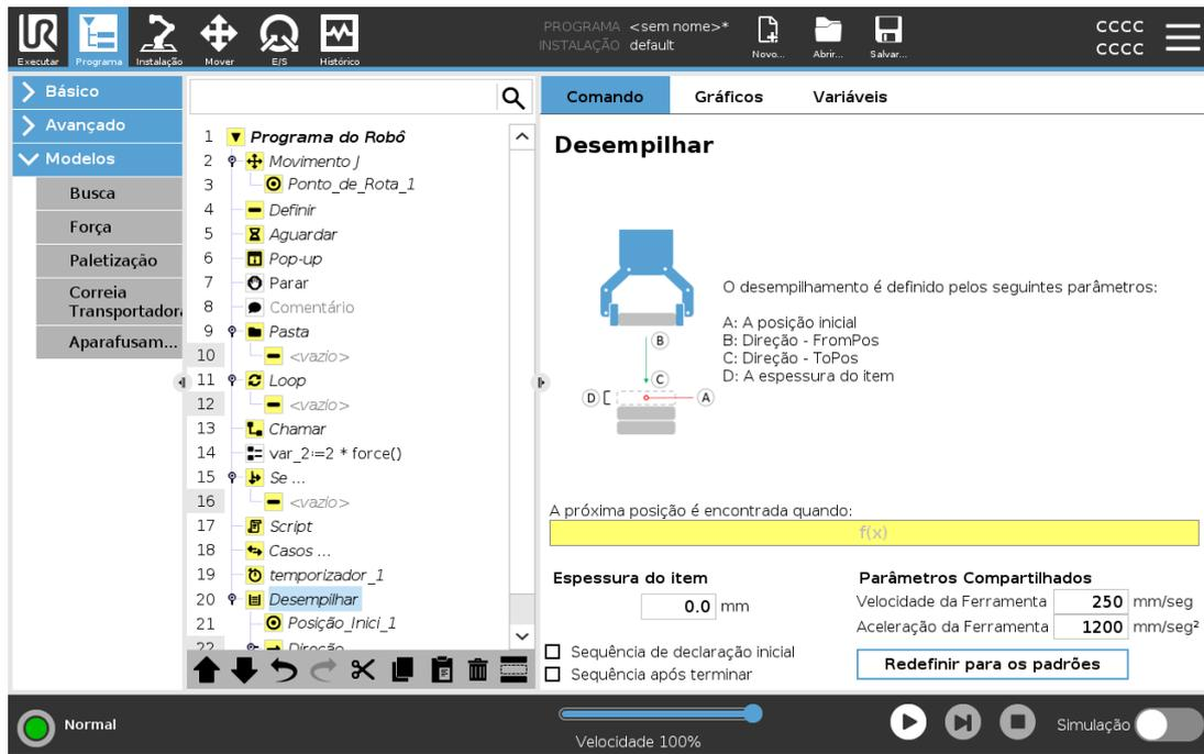
Ao desempilhar, o braço do robô move-se do ponto A, na direção oposta para procurar o próximo item. A condição na tela determina quando o próximo item é alcançado. Quando a condição é correspondida, o robô relembra da posição e executa a sequência especial.
