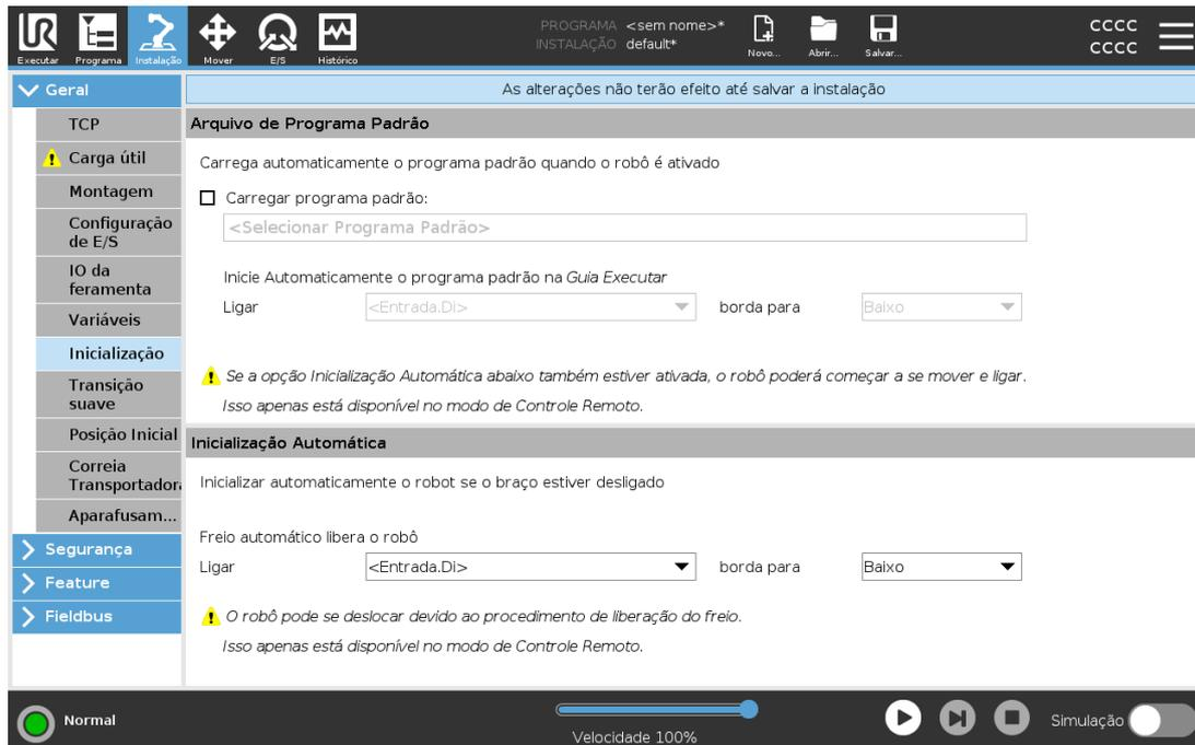
A tela de Inicialização contém configurações para carregar automaticamente e iniciar um programa padrão, bem como para inicializar automaticamente o Braço do robô durante a energização.
