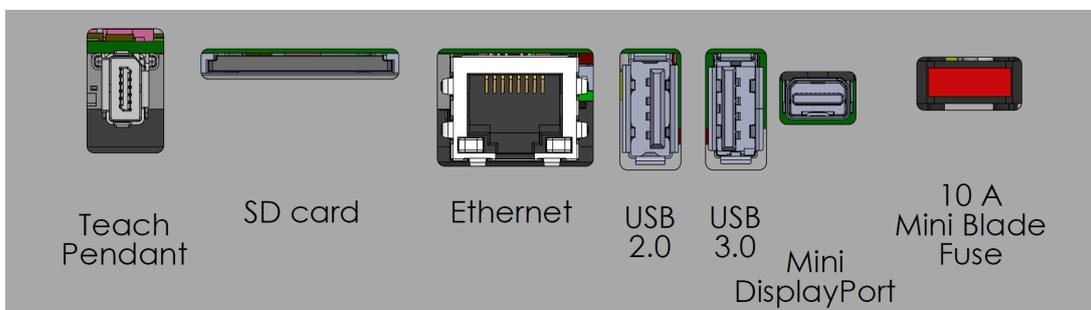
O fusível deve ter marca UL, tipo Mini lâmina com classificação máxima de corrente: 10A e classificação mínima de tensão: 32V
