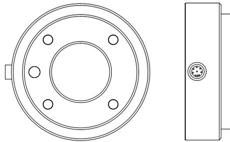
Este conector fornece sinais de energia e de controle para pinças e sensores usados em uma ferramenta de robô específica. O cabo industrial listado abaixo é apropriado:
