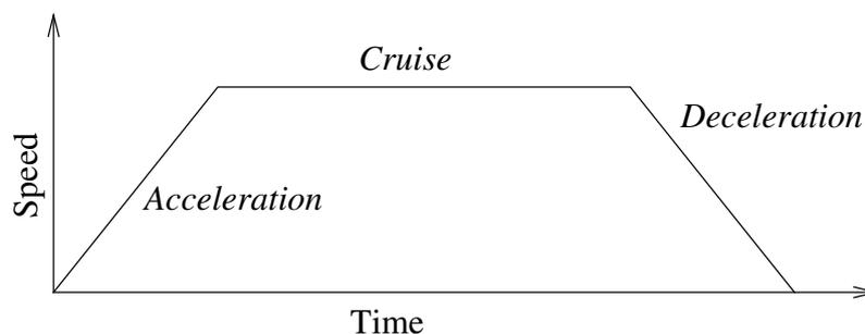
**23.1:** Perfil de velocidade para uma movimentação. A curva está dividida em três segmentos: aceleração, cruzeiro e desaceleração. O nível da fase de cruzeiro é dado pela definição da velocidade do movimento, enquanto a fase de declive da aceleração e desaceleração é dada pelo parâmetro de aceleração.
