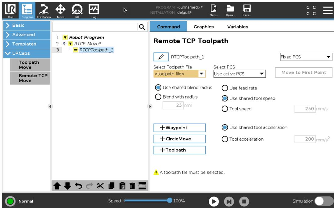
1. Carregue os arquivos Toolpath no diretório raiz de um dispositivo USB. Arquivos Toolpath devem ter a extensão .nc
