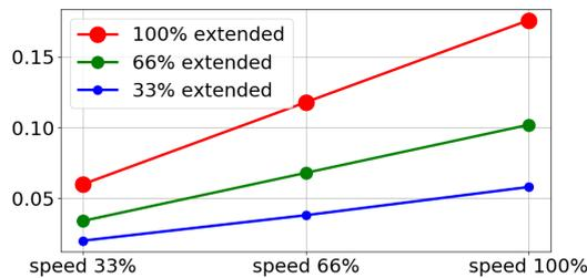
Tempo de paragem em segundos para uma carga útil máxima de 10kg
