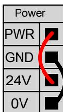
Se for necessário mais corrente, conecte uma fonte de alimentação externa conforme mostrado abaixo.
