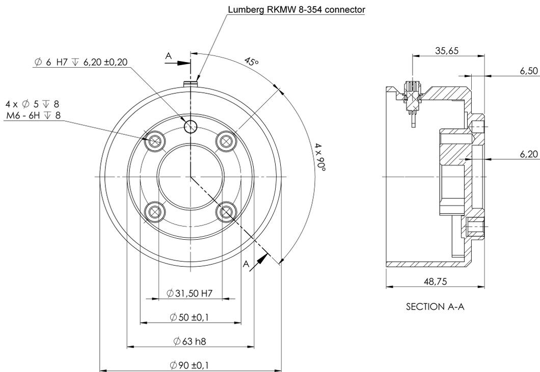
**5.2:** O flange de saída da ferramenta (ISO 9409-1-50-4-M6) é onde a ferramenta é montada na ponta do robô. Todas as medidas estão em mm.
