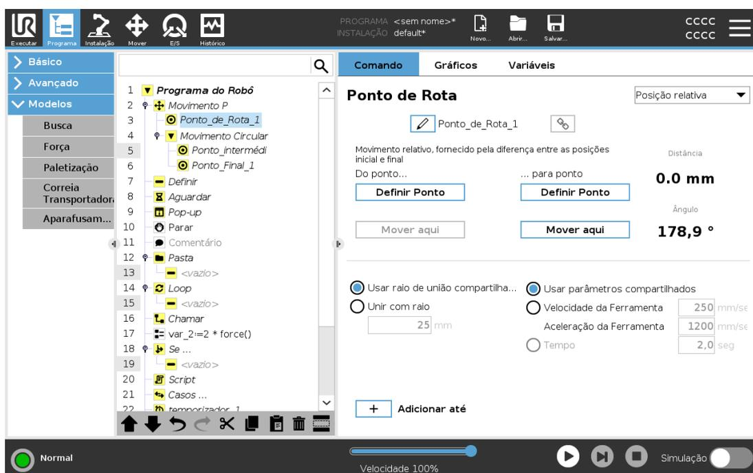
Um waypoint com a posição dada em relação à posição anterior do braço do robô, por ex. "dois centímetros para a esquerda". A posição relativa é definida como a diferença entre as duas posições dadas (da esquerda para a direita)..
