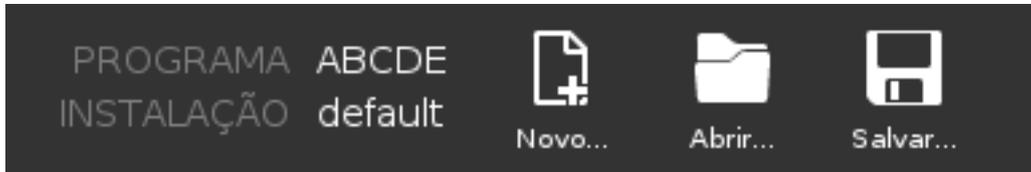
O Gestor de Programa e Instalação refere-se a três ícones que permitem criar, carregar e configurar Programas e Instalações: **Novo...**, **Abrir...** e **Guardar...**. O Caminho do Ficheiro mostra o nome do Programa carregado atual e o tipo de Instalação. O Caminho do Ficheiro muda quando é criado ou carregado um novo Programa ou Instalação. Você pode ter vários arquivos de instalação para um robô. Os programas criados carregam e usam a instalação ativa automaticamente.
