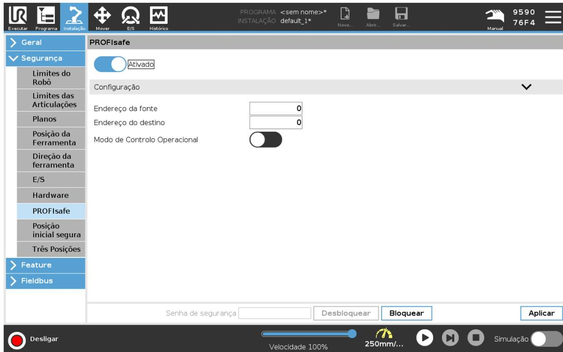
1. Ligue o robô a uma rede fiável que aceda a um PLC compatível com a segurança.
