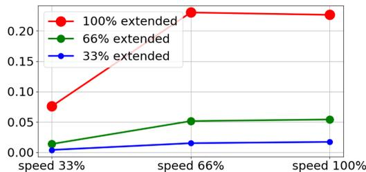
Distância de paragem em metros para uma carga útil máxima de 10kg
