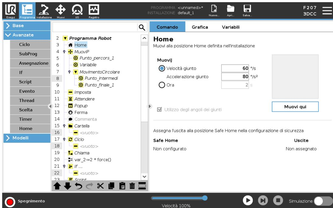
Il nodo Posizione principale utilizza gli angoli dei giunti per muovere il robot verso una Posizione principale predefinita. Se definito come una Posizione principale di sicurezza, il nodo Posizione principale viene visualizzato come Posizione principale (di sicurezza) nell'Albero del programma. Se la Posizione principale non è sincronizzata con la Posizione principale di sicurezza, il nodo non è definito.
