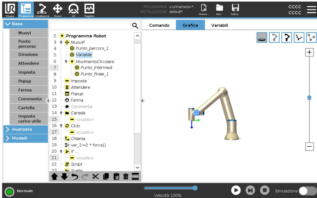
Se la posizione attuale del TCP del robot si avvicina a un piano di sicurezza o di attivazione o se l'orientamento dell'utensile del robot è prossimo alla soglia limite di orientamento dell'utensile (vedere [22.11. Piani a pagina 145](#)), viene visualizzata un'indicazione tridimensionale della soglia limite.
