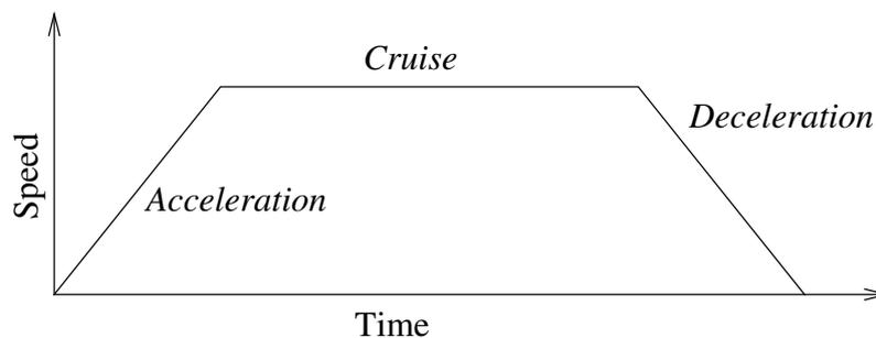
**23.1:** *Profilo di velocità di un movimento. La curva è suddivisa in tre segmenti: accelerazione, crociera e decelerazione. Il livello della fase di crociera deriva dall'impostazione della velocità del movimento, mentre la ripidità delle fasi di accelerazione e decelerazione derivano dal parametro di accelerazione.*
