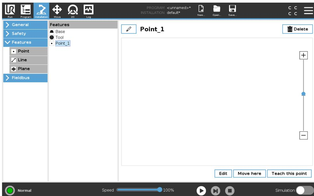
Usare Modifica per posizionare e spostare le feature senza muovere il braccio del robot, in modo che la feature possa essere posizionata al di fuori della portata del braccio del robot.
