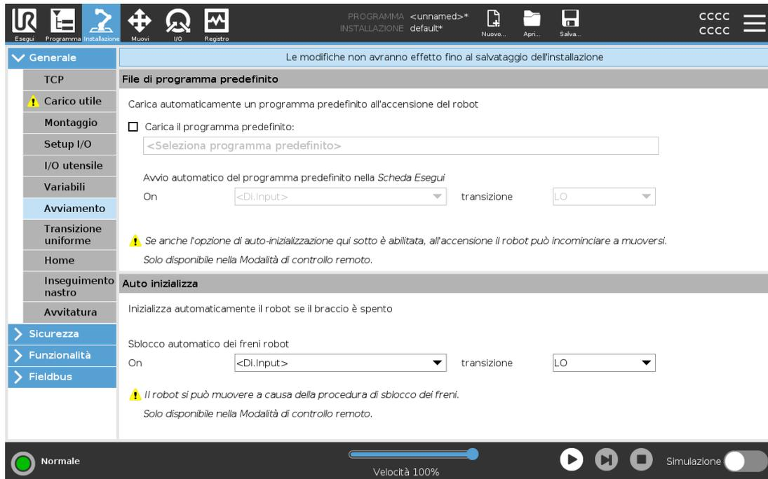
La schermata Avvio contiene le impostazioni per il caricamento e l'avvio automatico di un programma predefinito e per l'inizializzazione automatica del braccio del robot durante l'accensione.
