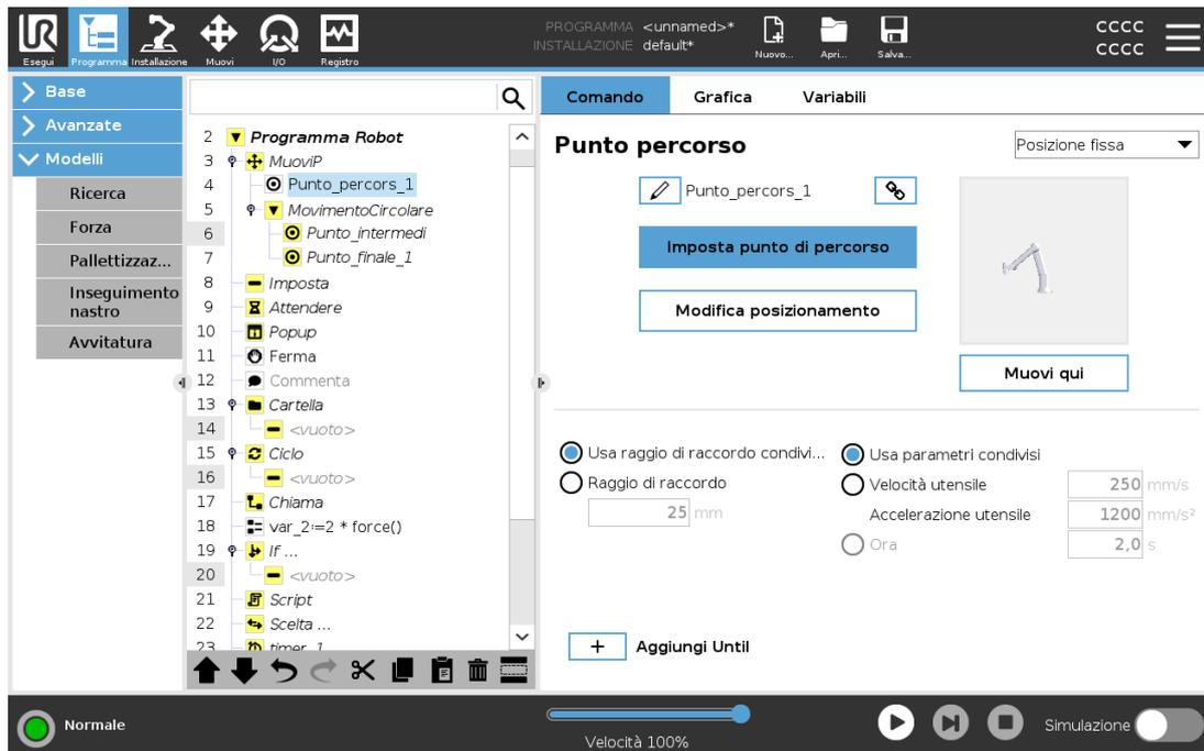
Un punto sul percorso del robot. I punti percorso sono la parte più centrale di un programma robot e comunicano al braccio del robot dove andare. Un punto percorso in posizione fissa viene insegnato spostando fisicamente il braccio robot su tale posizione.
