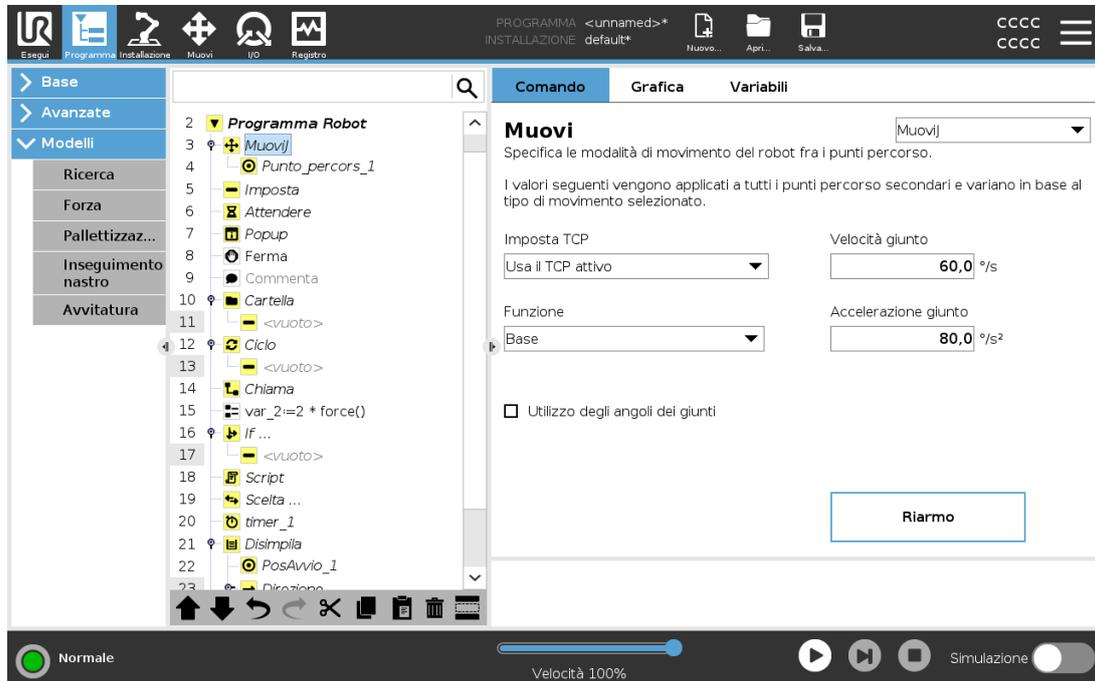
Il comando **Muovi** controlla il movimento del robot attraverso i punti percorso sottostanti. I punti percorso devono trovarsi in un comando Muovi. Il comando Muovi definisce l'accelerazione e la velocità con cui il braccio del robot si muoverà tra quei punti percorso.
