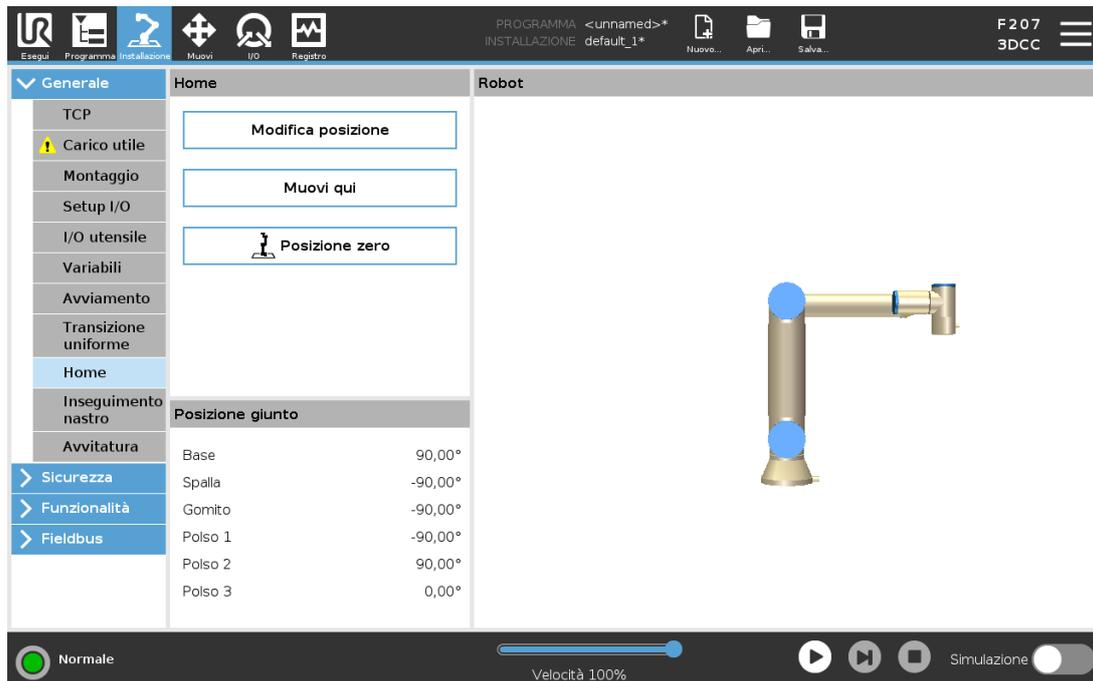
La Posizione principale è una posizione di ritorno definita dall'utente per il braccio del robot. Una volta definita, la Posizione principale è disponibile quando si crea il programma di un robot. È possibile utilizzare la Posizione principale per definire una Posizione principale di sicurezza (vedere [22.18. Posizione principale di sicurezza a pagina 155](#)) Utilizzare i pulsanti della schermata Home per quanto segue:
