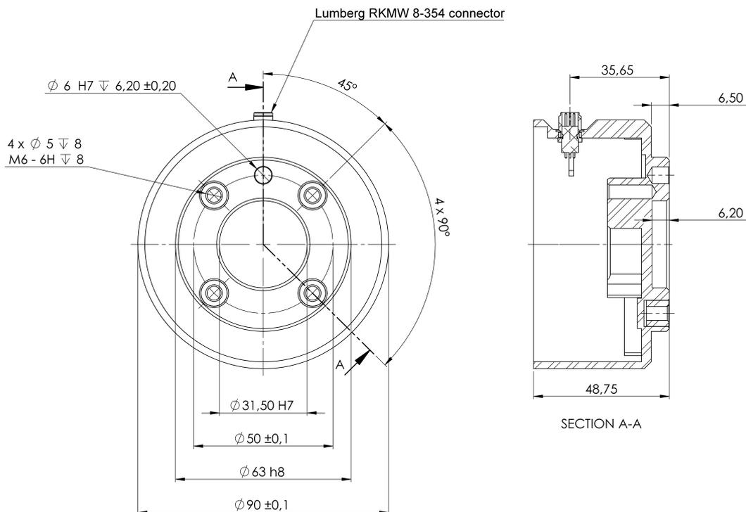
**5.2:** La flangia di uscita dell'utensile (ISO 9409-1-50-4-M6) rappresenta il punto in cui l'utensile viene installato all'estremità del robot. Tutte le misure sono in mm .
