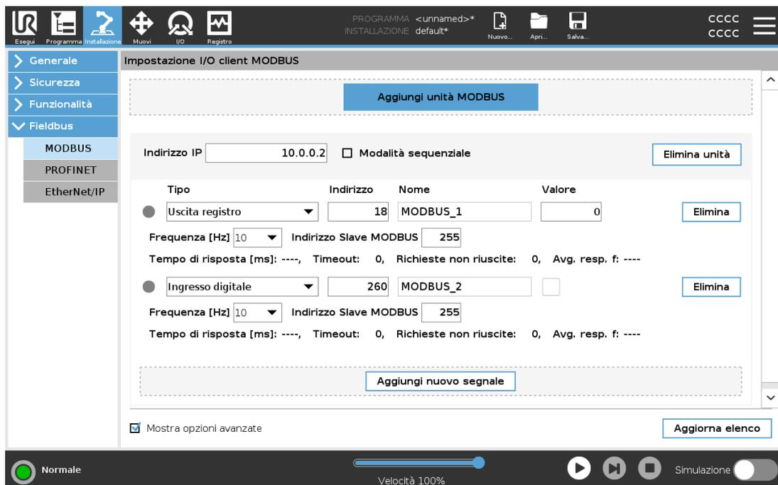
Qui è possibile impostare i segnali del client MODBUS (master). È possibile creare server (o slave) MODBUS su indirizzi IP specifici con segnali di input/output (registri o digitali). Ciascun segnale possiede un nome univoco per l'utilizzo nei programmi.
