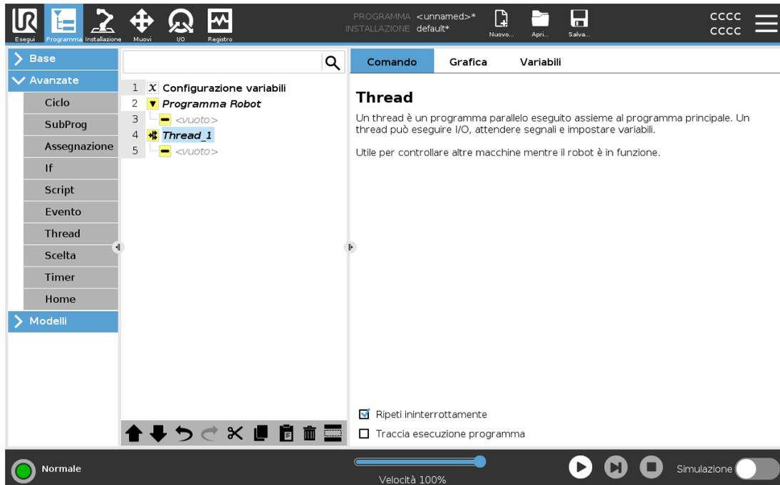
Un thread è un processo parallelo al programma robot. Un thread può essere utilizzato per controllare una macchina esterna indipendentemente dal braccio robot. Un thread può comunicare con il programma robot con variabili e segnali di uscita.
