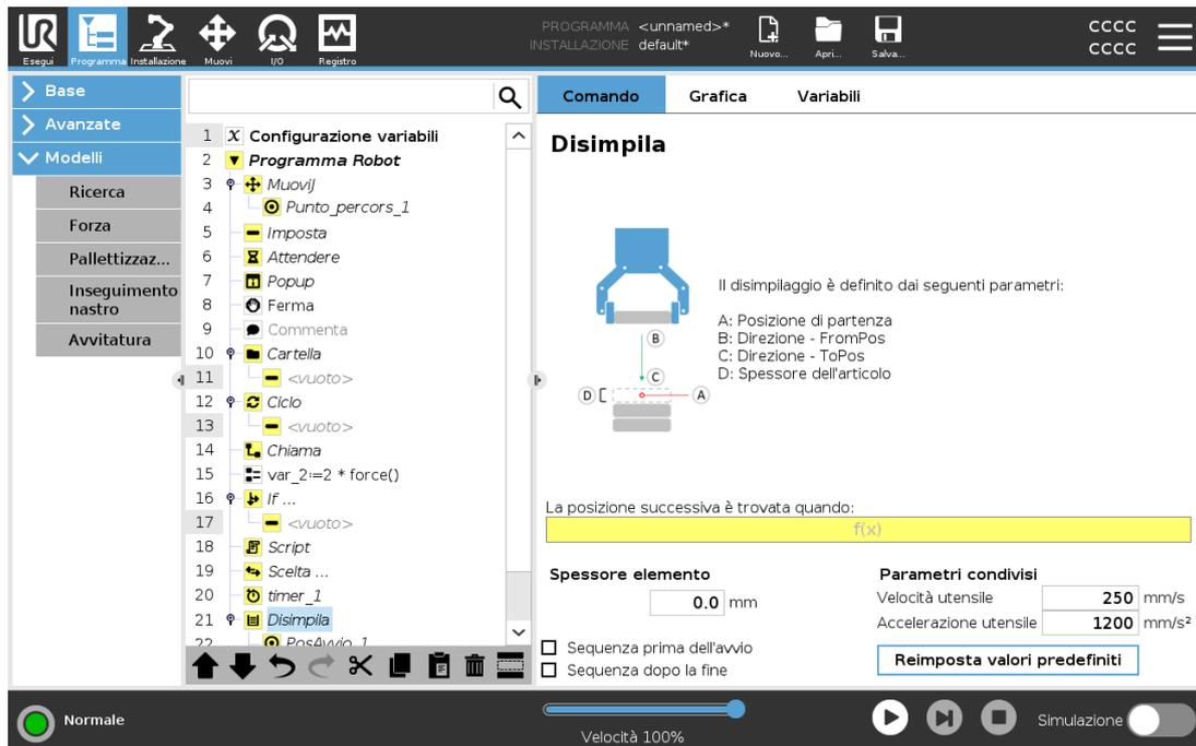
Durante il deimpilaggio, il braccio del robot si sposta dalla posizione A nella direzione indicata per cercare l'elemento successivo. La condizione sullo schermo determina quando si è raggiunto l'elemento successivo. Una volta soddisfatta la condizione, il robot ricorda la posizione ed esegue la sequenza speciale.
