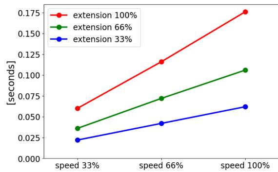
Tempo di arresto in secondi per il 66% di 12,5 kg
