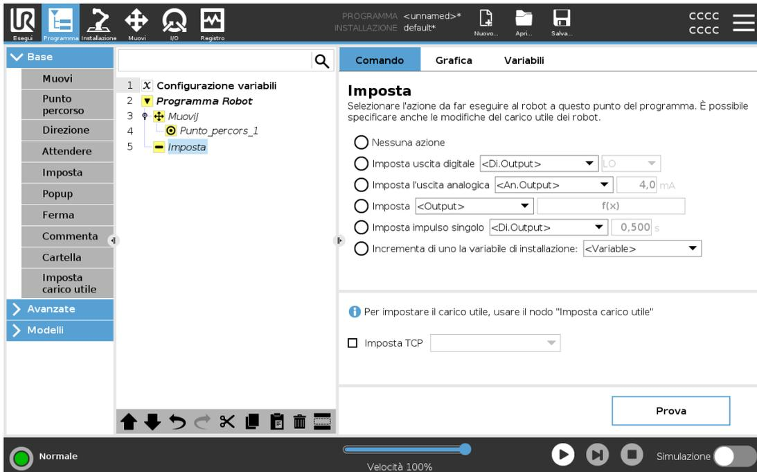
Se il TCP attivo per un movimento particolare è noto al momento della scrittura del programma, è possibile usare la selezione TCP toccando la scheda **Muovi** nel menu laterale sinistro (vedere [24.11.1. Muovi a pagina 175](#)). Per ulteriori informazioni sulla configurazione dei TCP nominati, (vedere [25.2. Configurazione centro utensile a pagina 229](#)).
