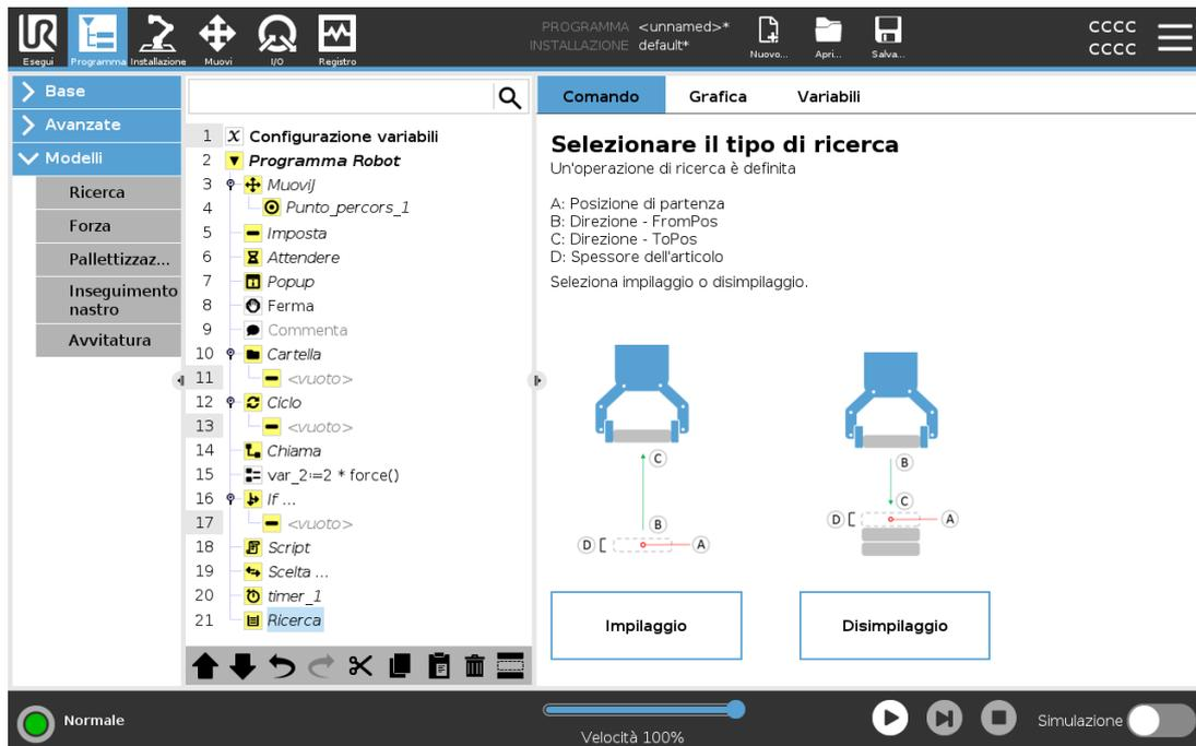
Durante l'impilaggio, il braccio del robot raggiunge la posizione *A* e si muove in direzione *opposta* per cercare la posizione della pila successiva. Una volta trovata la posizione della pila successiva, il robot la ricorda ed esegue la sequenza speciale.
