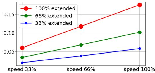
Tempo di arresto in secondi per il carico utile massimo di 10 kg
