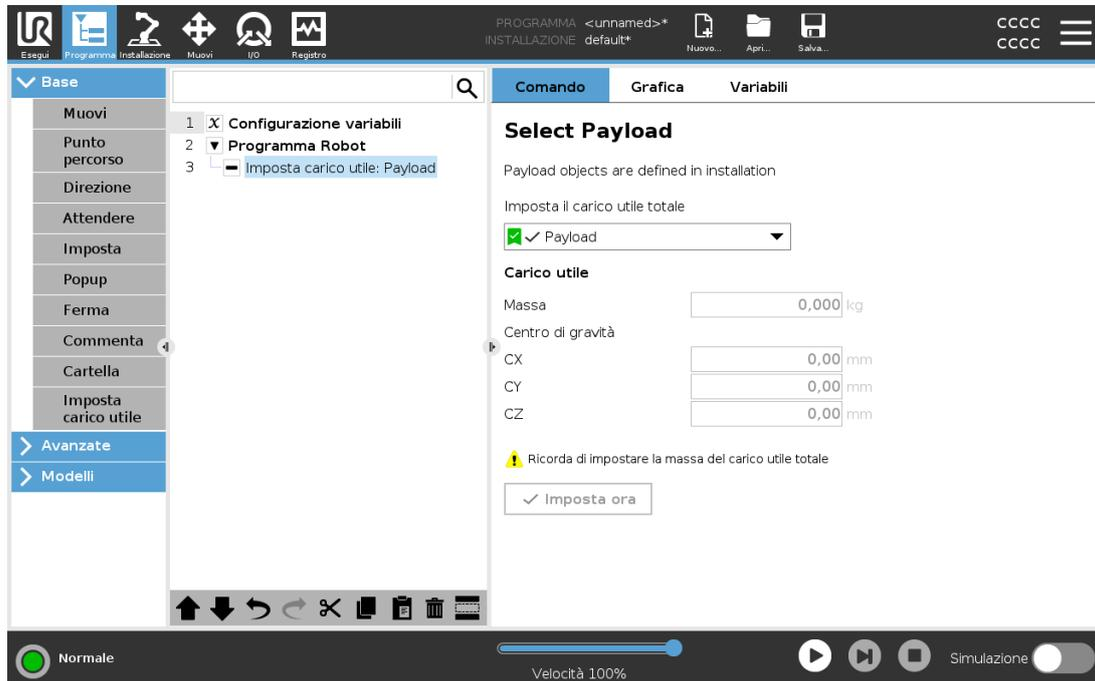
Usare il comando **Imposta carico utile** per impostare il carico utile del braccio del robot. La regolazione del peso del carico utile consente di evitare che, quando il peso all'utensile è diverso da quello previsto del carico utile, il robot inneschi un arresto di protezione.
