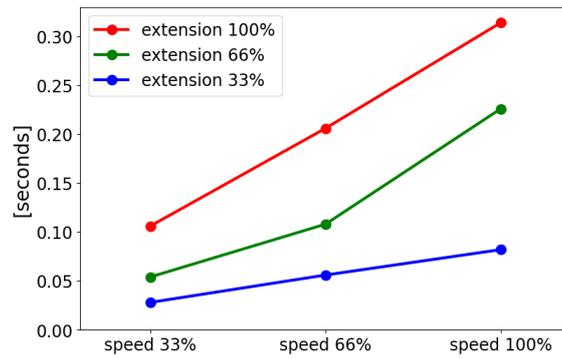
Tempo di arresto in secondi per il carico utile massimo di 12,5 kg
