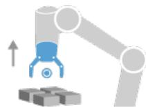
**Punto percorso di uscita:** direzione e posizione senza collisioni che il robot deve adottare quando si allontana da un elemento in un livello.
