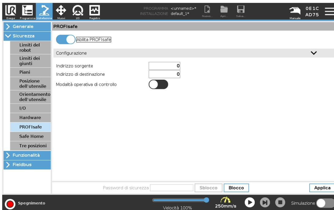
1. Connettere il robot a una rete fidata che accede a un PLC conforme alle norme di sicurezza.
