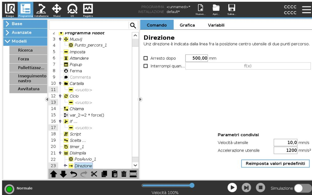
La direzione, espressa in base alle posizioni *da B a C*, è calcolata come la differenza di posizione dal TCP di *B* al TCP di *C*.
