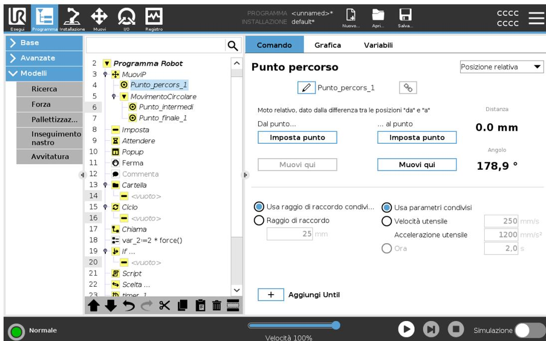
Un punto percorso con la posizione data in relazione alla posizione precedente del braccio del robot, ad esempio "due centimetri a sinistra". La posizione relativa è definita come differenza tra due posizioni date (da sinistra a destra).
