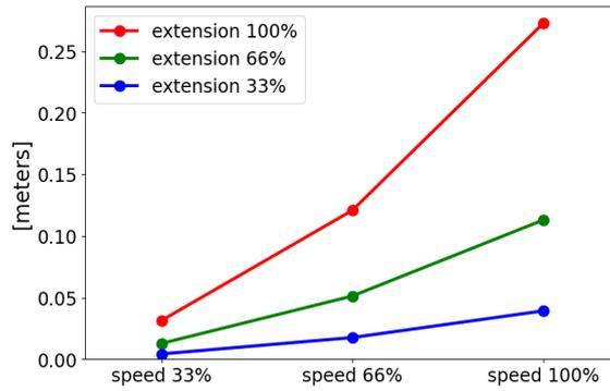
Distanza di arresto in metri per il carico utile massimo di 12,5 kg
