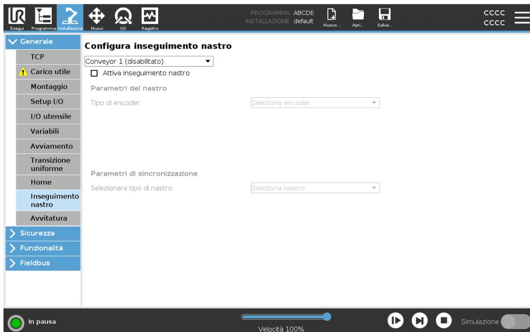
Il nodo del programma Tracciamento nastro è disponibile nella scheda Programma sotto Modelli. Tutti i movimenti sotto questo nodo sono consentiti durante la sincronizzazione nastro, ma sono vincolati al movimento del nastro. Le transizioni non sono connesse in uscita da Inseguimento nastro e pertanto il robot si ferma completamente prima di effettuare il prossimo movimento.
