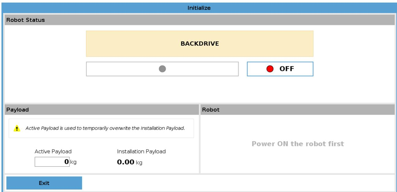
3. Muovere il robot come in modalità Freedrive. I freni del giunto vengono rilasciati ove necessario una volta attivato il pulsante Freedrive.
