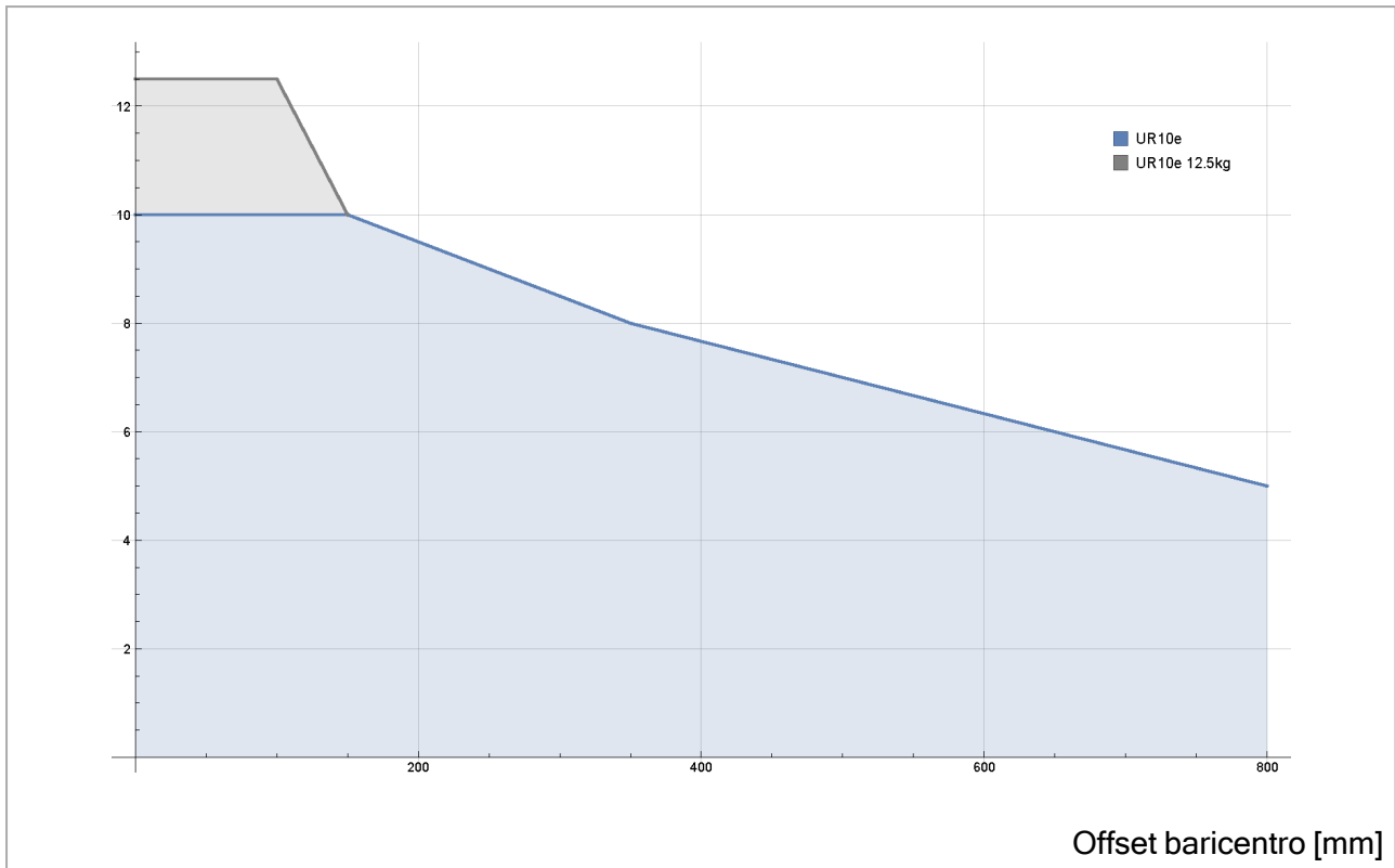
1.5: Rapporto fra il carico utile nominale e l'offset del centro di gravità.
