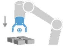
Die kollisionsfreie Position und Richtung, in die der Roboter bei der Annäherung an ein Element in einer Schicht verfahren soll.
