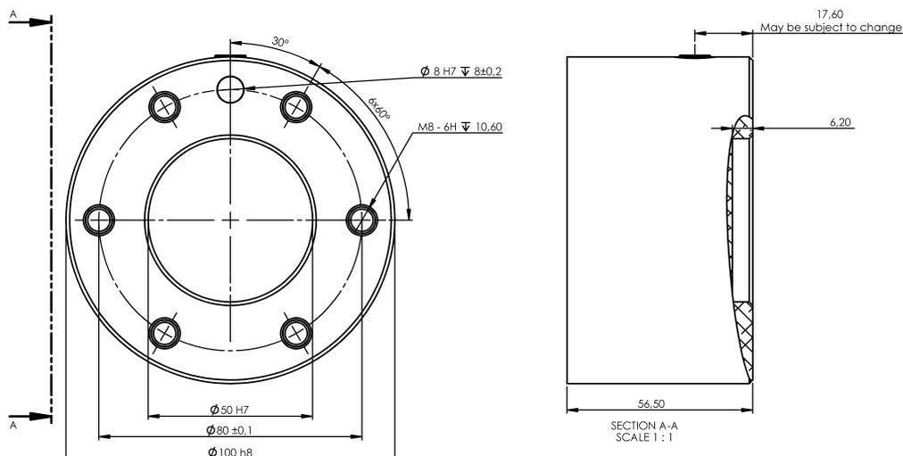
*Abmessungen und ein Lochbild des Werkzeugflanschs. Alle Maßangaben sind in mm.*
