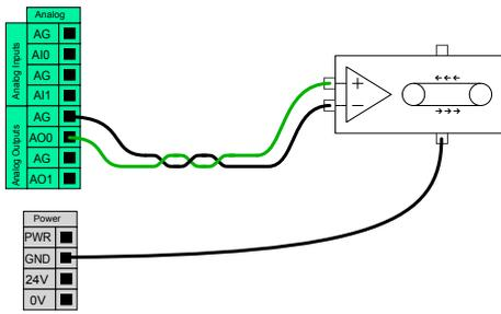
Dieses Beispiel zeigt, wie ein Fließband mit einem analogen Drehzahl-Steuerungseingang gesteuert werden kann.
