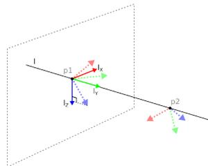
Hier sehen Sie, dass die Achse, die vom ersten Punkt zum zweiten Punkt gerichtet ist, die y-Achse des Linienkoordinatensystems bildet. Die z-Achse wird durch die Orientierung der z-Achse von  $p1$  definiert und steht senkrecht auf der Linie. Die Position des Koordinatensystems der Linie ist dieselbe wie die Position von  $p1$ .
