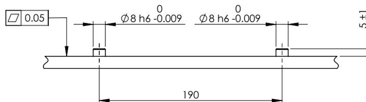
*Abmessungen und Lochmuster für die Montage des Roboters.*
