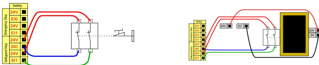
Dieses Beispiel zeigt einen Türschalter als grundlegende Sicherheitsvorrichtung, bei der der Roboter gestoppt wird, sobald die Tür geöffnet wird.
