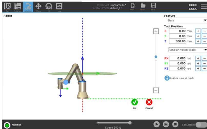
Bei Bedarf können Sie die Ebene später in den Sicherheitseinstellungen entweder in positiver oder negativer Z-Richtung verschieben.
