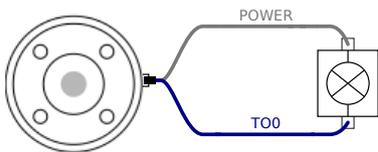
Dieses Beispiel veranschaulicht das Einschalten einer Last unter Verwendung der internen 12V- oder 24V-Stromversorgung.
