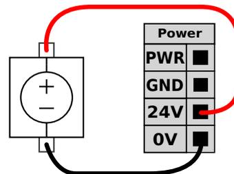
Dieses Beispiel veranschaulicht die Standardkonfiguration mit einer externen Stromversorgung für mehr Strom.
