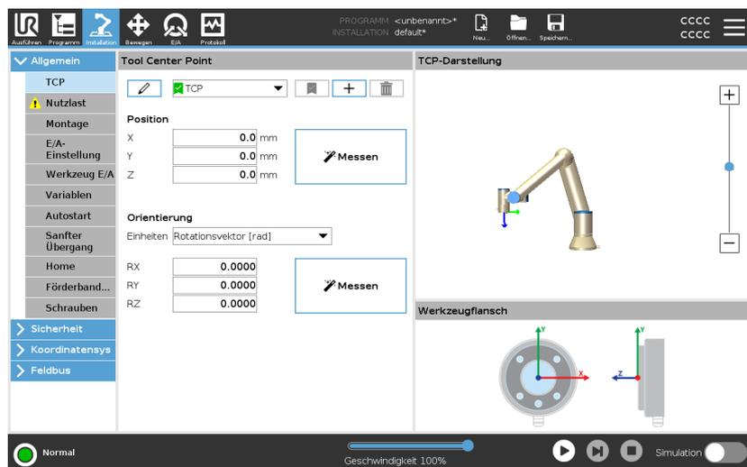
**Position** Die Koordinaten  $X$ ,  $Y$  und  $Z$  geben die TCP-Position an. Wenn alle Werte (auch die Ausrichtung) Null sind, liegt der TCP auf dem Mittelpunkt des Werkzeugflanschs und nimmt das auf dem Bildschirm dargestellte Koordinatensystem an.
