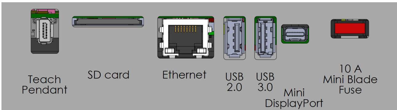
Sicherungsanforderung ist eine Miniflachsicherung mit UL-Kennzeichnung und einer maximalen Strombelastbarkeit von 10 A und einer Mindestspannung von 32 V
