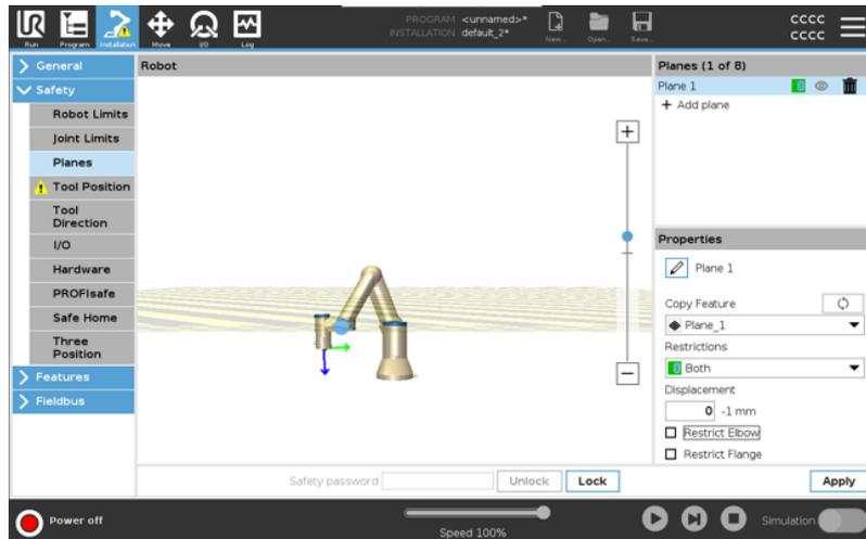
Der uneingeschränkte Werkzeugflansch kann eine Sicherheitsebene überqueren, auch wenn kein Werkzeug definiert ist.
