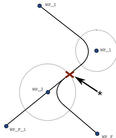
**34.2:** WP\_I ist der anfängliche Wegpunkt und es gibt zwei mögliche endgültige Wegpunkte WP\_F\_1 und WP\_F\_2, abhängig von einem bedingten Ausdruck. Die Bedingung `if` wird ausgewertet, sobald der Roboterarm die zweite Überblendung (\*) erreicht.
