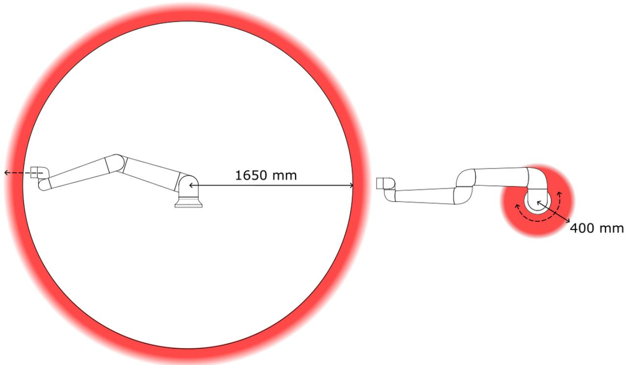
*Aufgrund der physikalischen Eigenschaften des Roboterarms erfordern bestimmte Arbeitsbereiche besondere Aufmerksamkeit wegen Quetschgefahr. Ein Bereich (links) ist für radiale Bewegungen definiert, wenn das Gelenk des Handgelenks 1 mindestens 1650 mm von der Basis des Roboters entfernt ist. Der andere Bereich (rechts) befindet sich innerhalb von 400 mm von der Basis des Roboters, wenn er sich tangential bewegt.*
