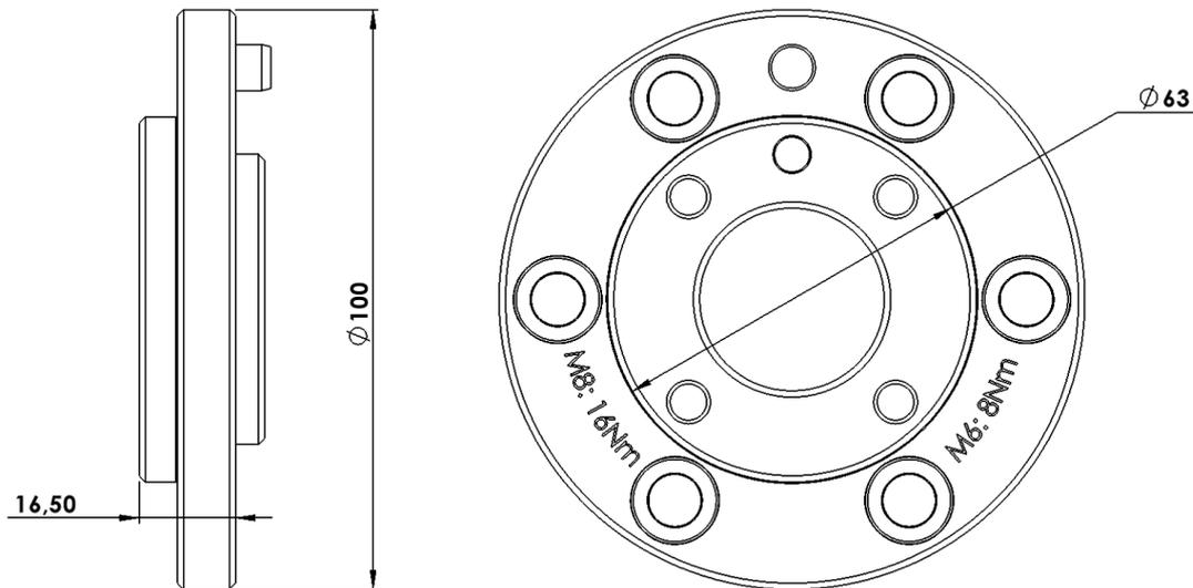
*Masseschwerpunkt und Schraubenanzugsmomente des Werkzeugflanschadapters.*
