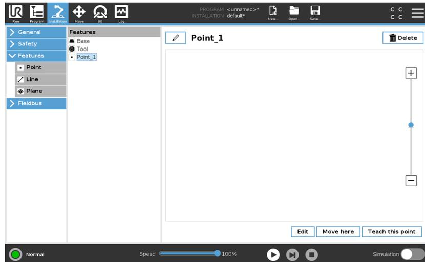
Verwenden Sie „Bearbeiten“, um Funktionen zu platzieren und zu verschieben, ohne den Roboterarm zu bewegen, sodass die Funktion außerhalb der Reichweite des Roboterarms platziert werden kann.
