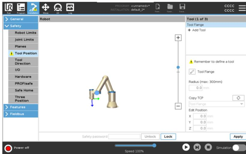
Die Schaltfläche der Werkzeugposition ohne Warnung zeigt an, dass ein Werkzeug (außer dem Werkzeugflansch) hinzugefügt wurde.
