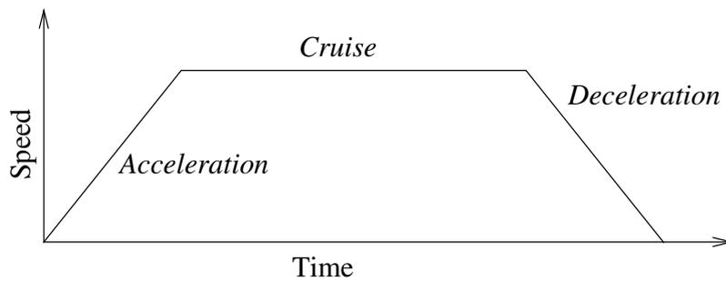
**31.1:** Geschwindigkeitsprofil für eine Bewegung. Die Kurve wird in drei Segmente unterteilt: Beschleunigung (Acceleration), konstante Bewegung (Cruise) und Verlangsamung (Deceleration). Die Ebene der konstanten Bewegung wird durch die Geschwindigkeitseinstellung der Bewegung vorgegeben, während der Anstieg und Abfall der Phasen in Beschleunigung und Verlangsamung durch den Beschleunigungsparameter vorgegeben wird.
