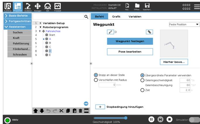
Wenn das Programm läuft, wird der aktuell ausgeführte Programmknoten durch ein kleines Symbol neben dem Knoten angezeigt.
