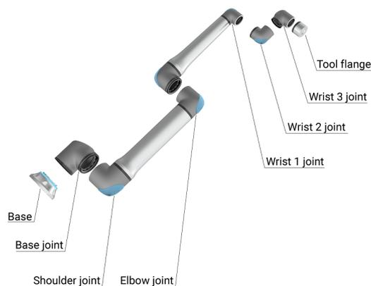
*Die Gelenke, die Basis und der Werkzeugflansch am Roboterarm.*
