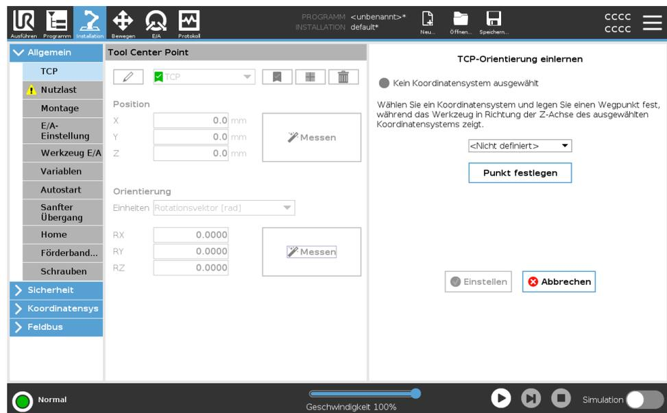
Obwohl drei Positionen ausreichend sind, um den TCP zu bestimmen, kann die vierte Position dazu beitragen, sicherzustellen, dass die Berechnung korrekt ist. Die Qualität jedes gespeicherten Punktes in Bezug auf den berechneten TCP wird mit einer grünen, gelben oder roten LED auf der jeweiligen Taste signalisiert.
