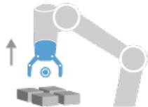
Die Position und Richtung, in die der Roboter beim Entfernen von einem Element in einer Schicht verfahren soll.
