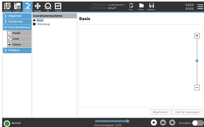
Der Roboter verfügt über zwei vordefinierte Koordinatensysteme, die unten aufgeführt sind, mit Posen, die durch die Konfiguration des Roboterarms selbst definiert sind:
