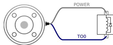
Dieses Beispiel veranschaulicht die Verwendung einer empfohlenen Schutzdiode für induktive Lasten.
