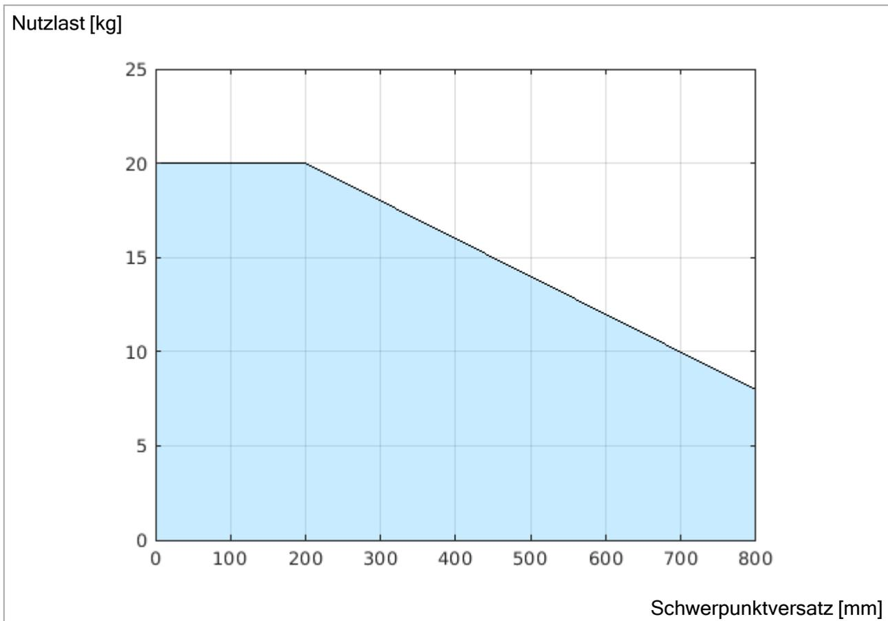
*Beziehung zwischen der Nennnutzlast und der Schwerpunktverschiebung.*
