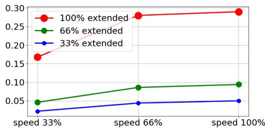
Tempo di arresto in secondi per il carico utile massimo di 10 kg
