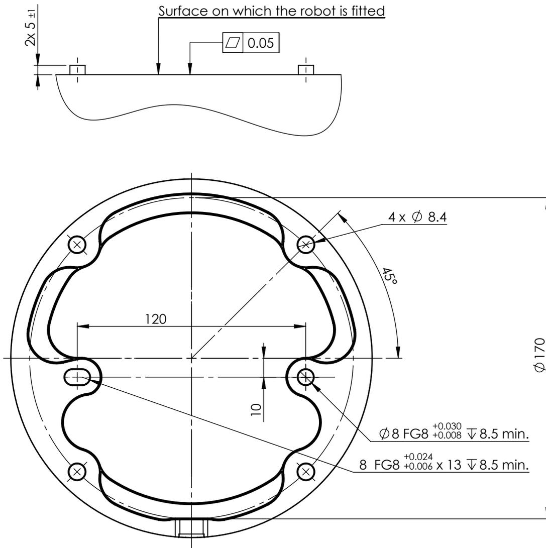
**2.2:** Dimensioni e schema dei fori per il montaggio del robot.
