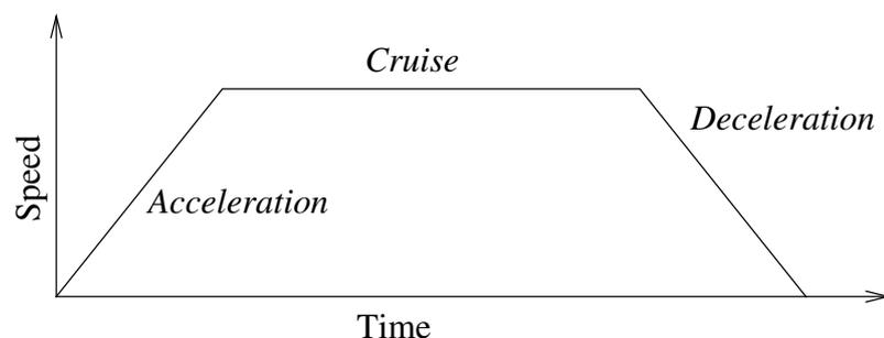
**30.1:** *Profilo di velocità di un movimento. La curva è divisa in tre segmenti: accelerazione, crociera e decelerazione. Il livello della fase di crociera deriva dall'impostazione della velocità del movimento, mentre la ripidità delle fasi di accelerazione e decelerazione derivano dal parametro di accelerazione.*
