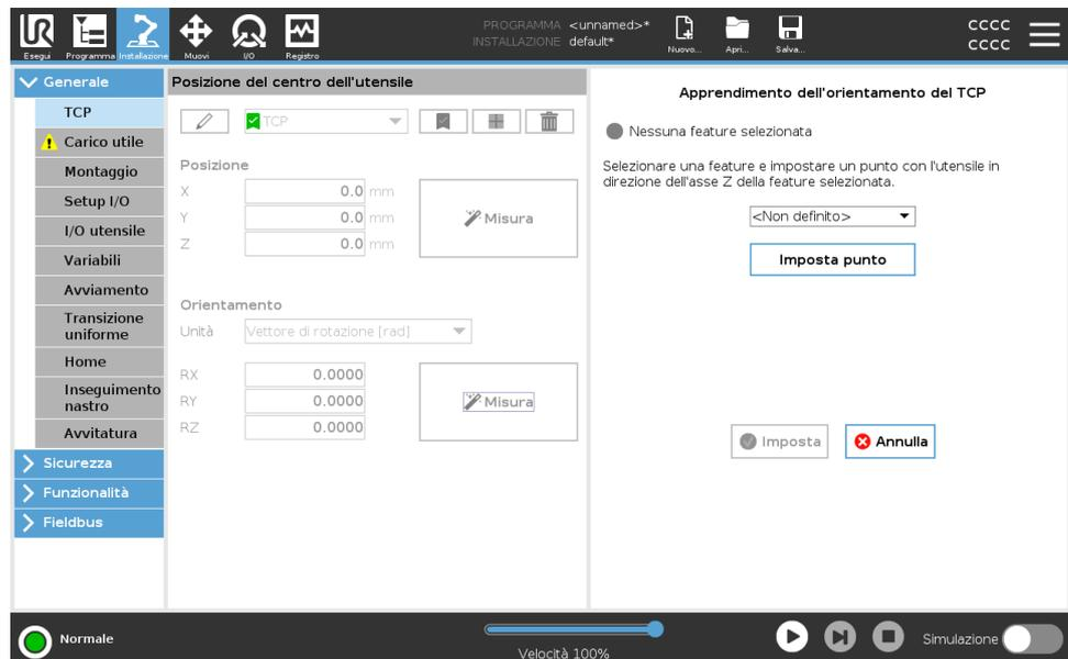
Nonostante tre posizioni siano sufficienti alla determinazione del TCP, è possibile utilizzare una quarta posizione per un'ulteriore verifica della correttezza del calcolo. La qualità di ciascun punto salvato relativamente al TCP calcolato viene indicata mediante un LED verde, giallo o rosso sul rispettivo pulsante.
