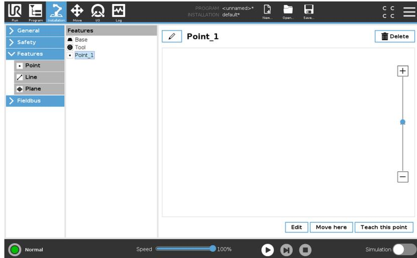
Usare Modifica per posizionare e spostare le feature senza muovere il braccio del robot, in modo che la feature possa essere posizionata al di fuori della portata del braccio del robot.
