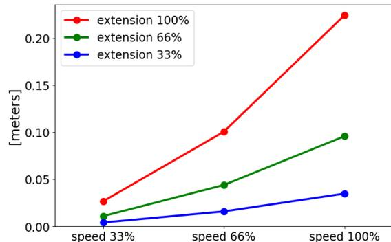
Distanza di arresto in metri per il 33% di 12,5 kg
