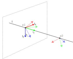
Qui puoi vedere che l'asse diretto dal primo punto al secondo costituisce l'asse Y del sistema di coordinate della linea. L'asse Z è definito dalla proiezione dell'asse Z di  $p1$  sul piano perpendicolare alla linea. La posizione del sistema di coordinate della linea è identica alla posizione di  $p1$ .
