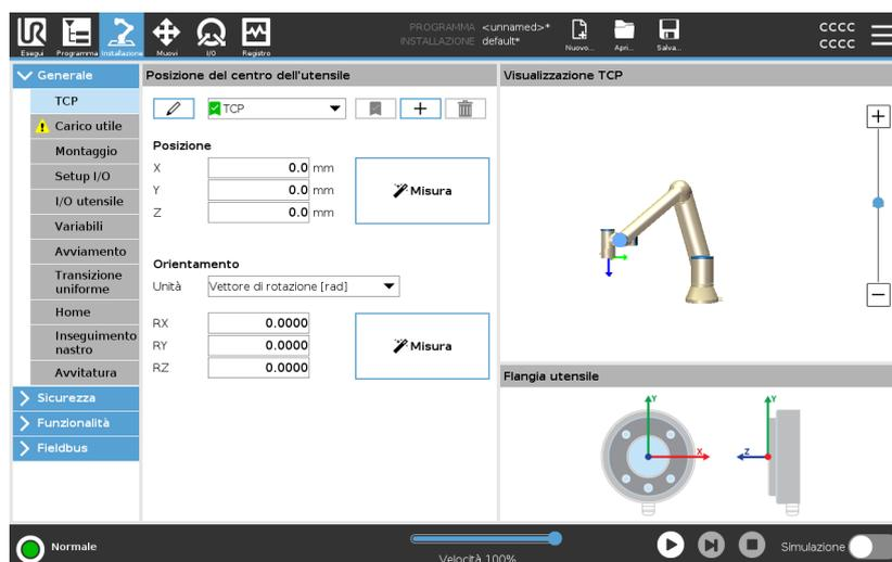
**Posizione** Le coordinate  $X$ ,  $Y$ ,  $Z$  specificano la posizione del TCP. Se tutti i valori (compreso l'orientamento) corrispondono a 0, il TCP coincide con il punto centrale della flangia di uscita dell'utensile e utilizza il sistema di coordinate visualizzato sullo schermo.
