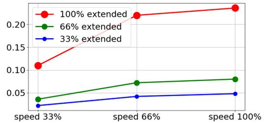
Tempo di arresto in secondi per il 33% di 10 kg
