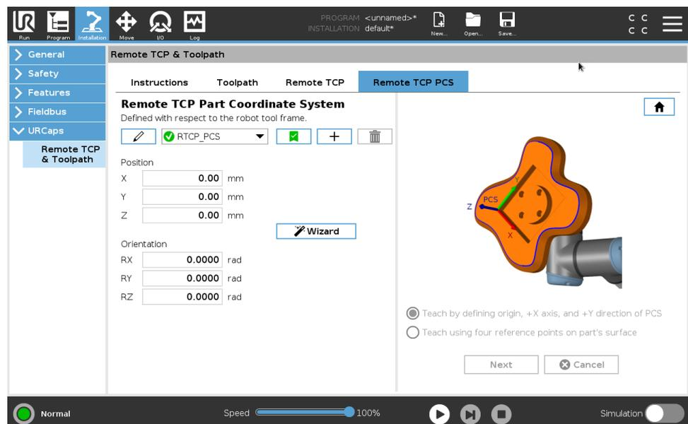
**Configurazione di un PCS del TCP remoto**
