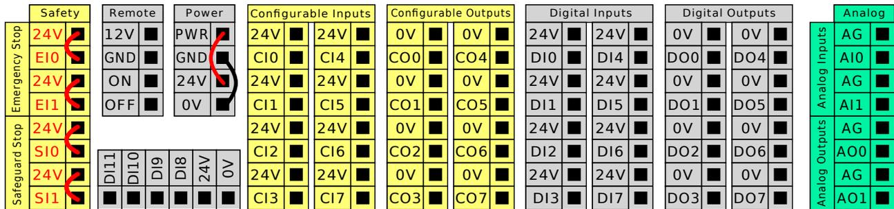
È possibile utilizzare il blocco degli ingressi digitali orizzontali (DI8-DI11), illustrato di seguito, per la codifica in quadratura del tracciamento del trasportatore (vedi 6.3.1. Specifiche comuni per tutte le I/O digitali sotto) per questi tipi di input.
