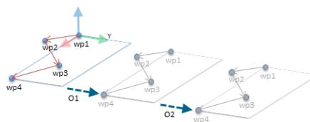
**54.3:** Applicazione di un offset alla caratteristica del piano
