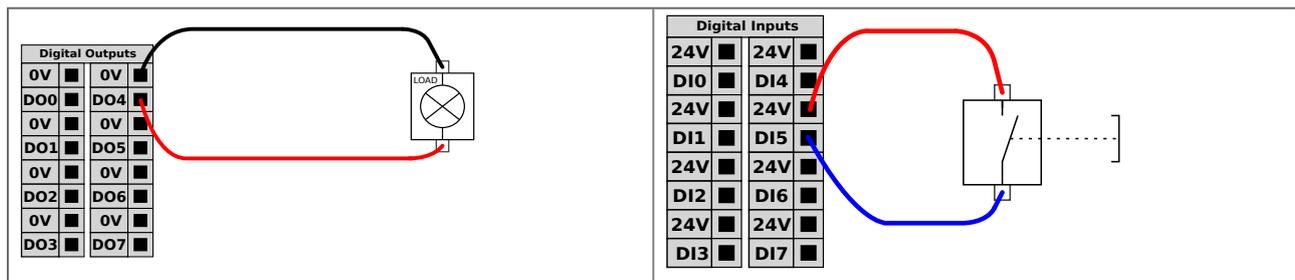
Questo esempio illustra come un carico viene controllato dalle uscite digitali quando connesso.
