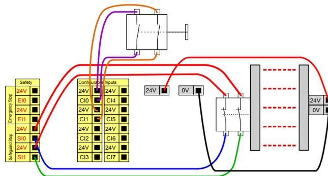
**In modalità manuale, devi premere il dispositivo di abilitazione a tre posizioni per spostare il robot.**
