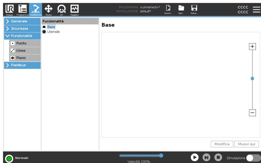
Il robot comprende due feature predefinite, elencate di seguito, con posizioni definite dalla configurazione del braccio del robot stesso:
