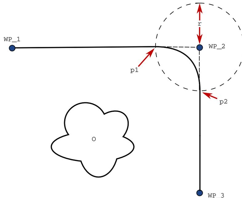
**32.2:** *Transizione lungo (WP\_2) con raggio ( $r$ ), posizione di transizione iniziale in  $p1$  e posizione di transizione finale in  $p2$ . (O) è un ostacolo.*
