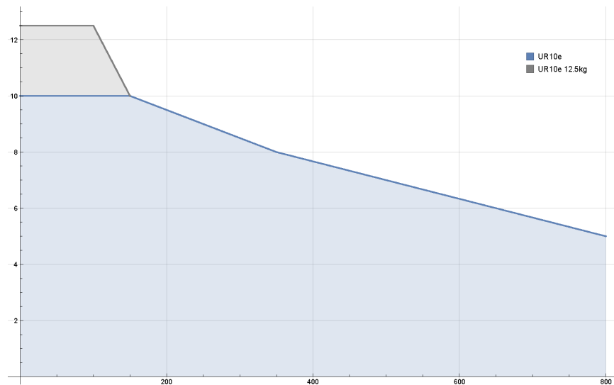
2.3: Relação entre a carga útil nominal e o deslocamento do centro de gravidade.
