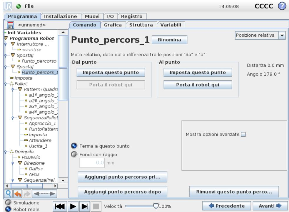
Un punto percorso con la posizione data in relazione a quella precedente del braccio robot, ad esempio “due centimetri a sinistra”. La posizione relativa è definita come differenza tra due posizioni date (da sinistra a destra). Si noti che le posizioni relative ripetute possono portare il braccio robot fuori dalla propria area di lavoro.
