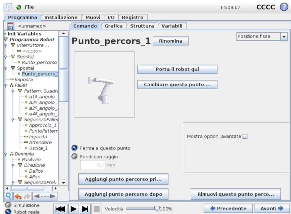
Un punto sul percorso del robot. I punti percorso sono la parte più centrale di un programma robot e comunicano al braccio robot dove andare. Un punto percorso in posizione fissa viene dato spostando fisicamente il braccio robot su tale posizione.
