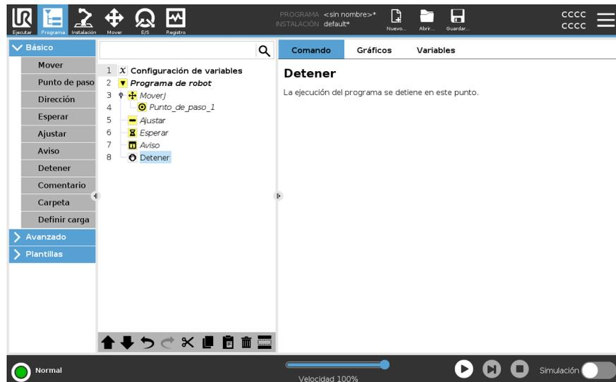
**Ejemplo: Detener** Si no hay más piezas de una aplicación de soldadura, o una de las piezas se ha colocado incorrectamente en el patrón de soldadura, puede añadir un comando Detener.
