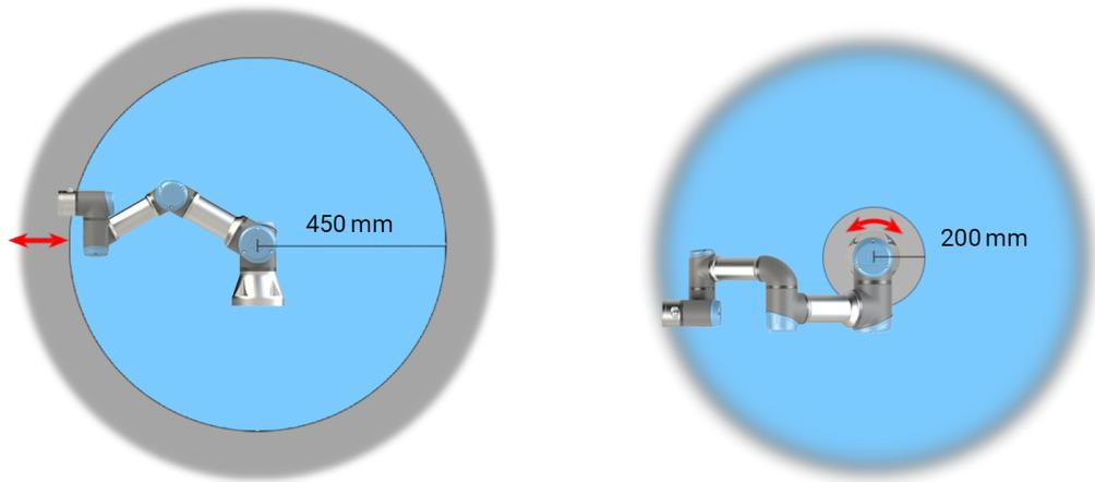
*À cause des propriétés physiques du bras du robot, certaines zones de l'espace de travail nécessitent une attention particulière quant aux risques de pincement. Une zone (à gauche) est définie pour les mouvements radiaux, lorsque l'articulation du poignet 1 est à au moins 450 mm de la base du robot. L'autre zone (à droite) est à 200 mm de la base du robot, lorsqu'il se déplace dans la direction longitudinale.*
