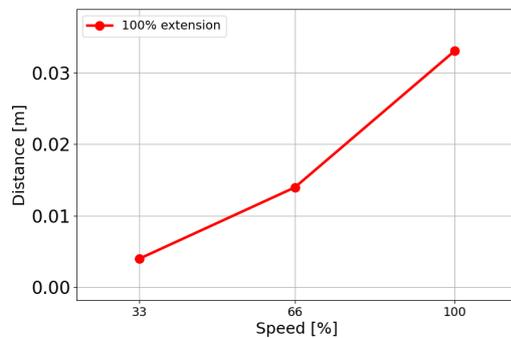
Distance d'arrêt en mètres pour une charge utile maximale de 3 kg
