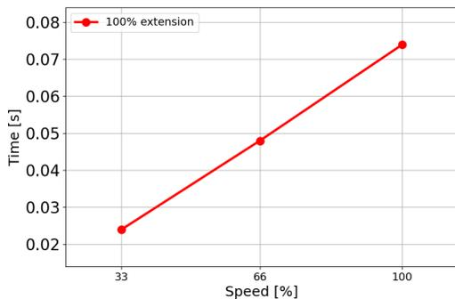
Temps d'arrêt en secondes pour une charge utile maximale de 3 kg
