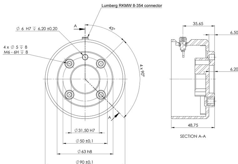
Dimensions et le modèle de trous de la bride de l'outil. Toutes les mesures sont en millimètres.
