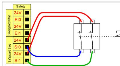
Cet exemple illustre un contacteur de porte en tant que dispositif de sécurité de base qui permet d'arrêter le robot à l'ouverture de la porte.
