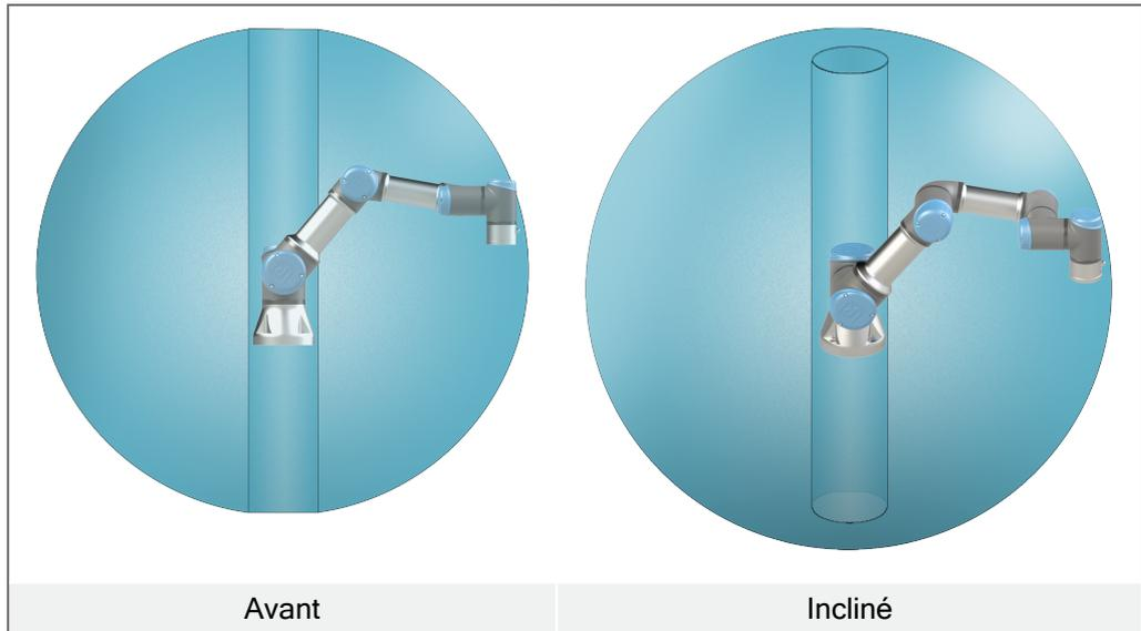
À cause des propriétés physiques du bras du robot, certaines zones de l'espace de travail nécessitent une attention particulière quant aux risques de pincement. Une zone (à gauche) est définie pour les mouvements radiaux, lorsque l'articulation du poignet 1 est à au moins 450 mm de la base du robot. L'autre zone (à droite) est à 200 mm de la base du robot, lorsqu'il se déplace dans la direction longitudinale.
