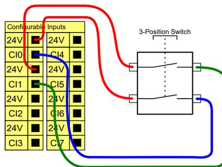
Remarque : les deux canaux d'entrée de l'entrée du dispositif d'activation trois positions ont une tolérance de désaccord de 1 seconde.
