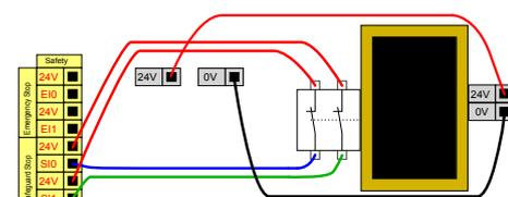
Cet exemple illustre un tapis de sécurité en tant que dispositif de sécurité pour lequel la reprise automatique est appropriée. Cet exemple est également valable pour un scanner laser de sécurité.
