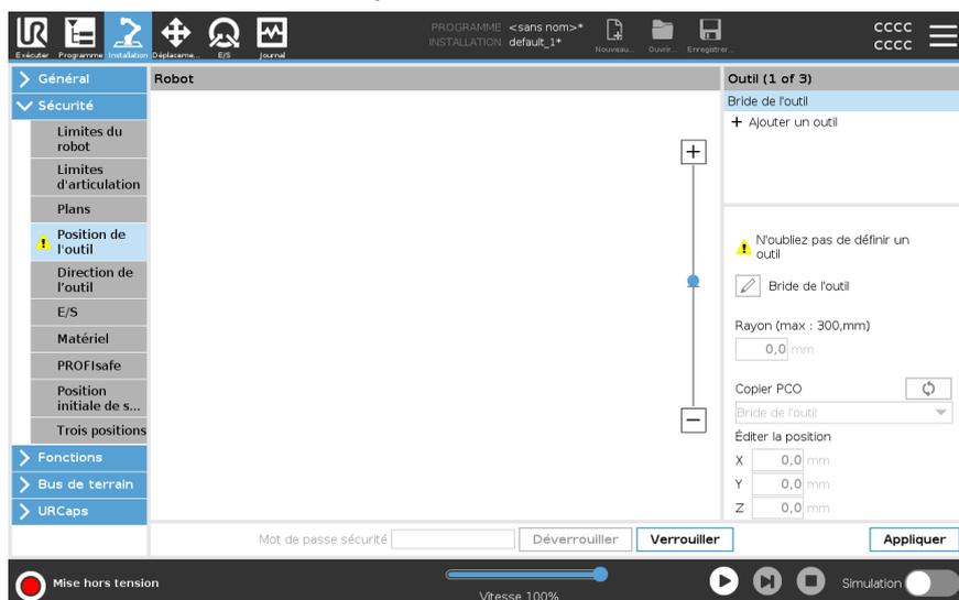
**Avertissement de position de l'outil** Vous devez définir une position d'outil dans les paramètres de sécurité, pour que le plan de sécurité se déclenche correctement lorsque le PCO de l'outil s'approche du plan de sécurité.
