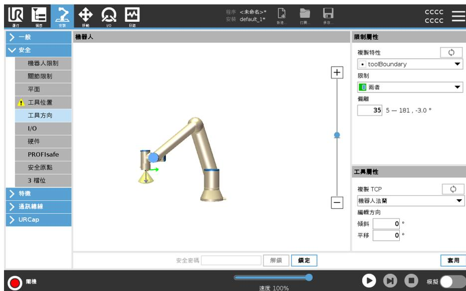
**限制屬性** 工具方向限制有三種可配置屬性：
