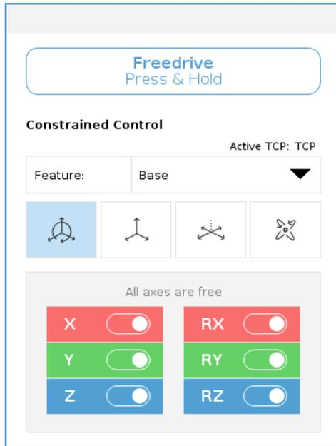
**圖示** 您可以鎖定一個或多個軸，以允許 TCP 在下表所定義的特定方向上移動。
