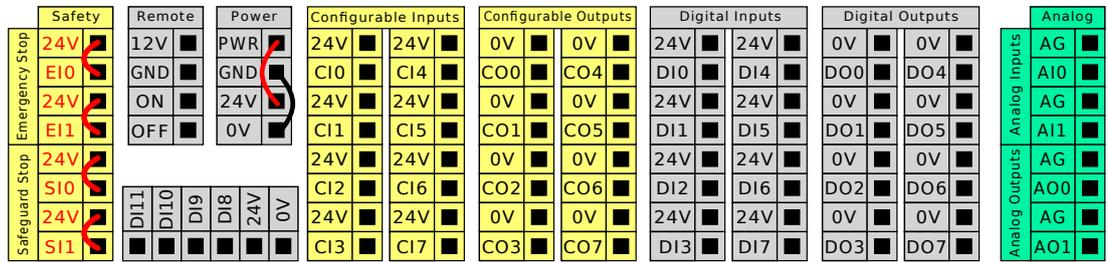
可使用下圖所示的水平數位輸入塊 (DI8-DI11) 進行正交編碼輸送帶追蹤。
