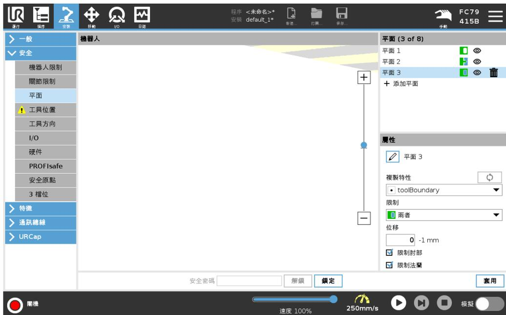
**肘部限制** 您可以启用 **限制肘部**，以防止机器人肘关节穿过您定义的任何平面。禁用限制肘部，以使肘部穿过平面。
