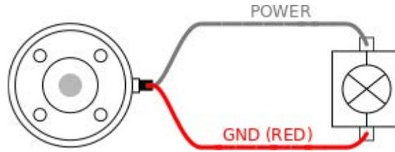
**雙 Pin 電源** 在雙 Pin 電源模式下，可以增加輸出電流，如工具 I/O 所示。
