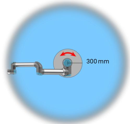
由於機械手臂的物理特性，某些工作空間區域需要注意捏造危險。其中一個區域(左)是定義的徑向運動區域，即手腕關節 1 至少與機器人底座相距 1300 mm 的區域。另一個區域(右)是在機器人底座 300 mm 範圍內的區域(機器人按正切方向移動時)。
