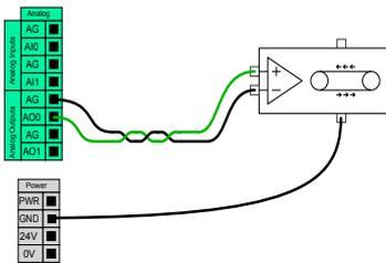
本例顯示了如何利用模擬速度控制輸入來控制輸送機。
