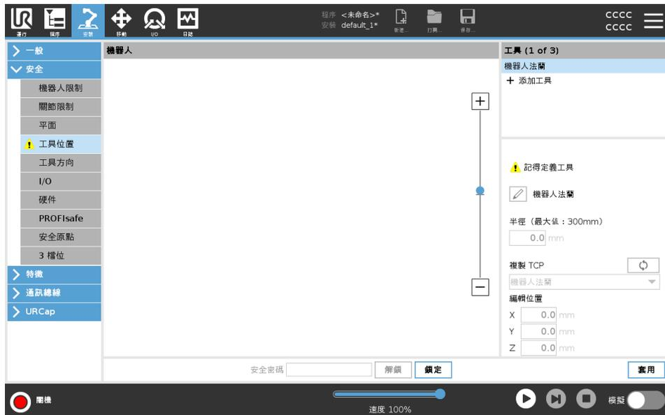
**工具位置警告** 您必須在安全設定中設定「工具位置」，以讓工具 TCP 接近安全平面時正確觸發安全平面。
