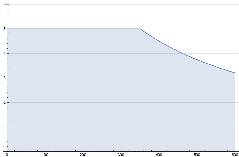
2.4: La relation entre la charge utile nominale et le décalage du centre de gravité.
