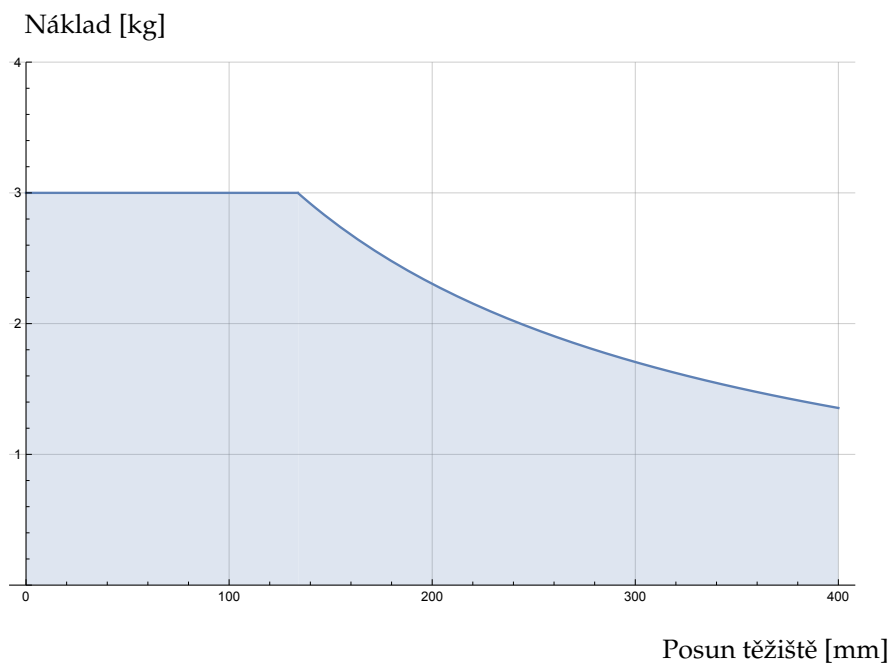
Obrázek 4.3: Vztah mezi maximálním povoleným nákladem a posunem těžiště.
