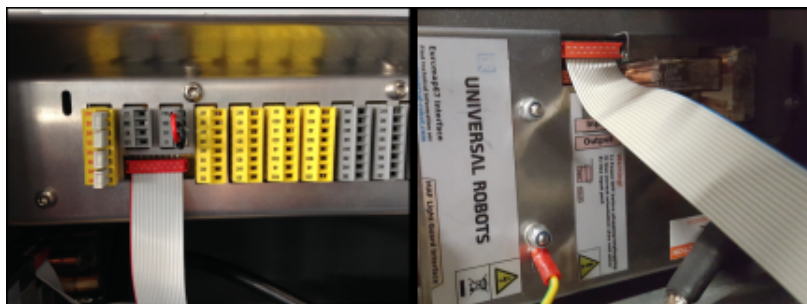
Obrázek 19.1: Připojení plochého kabelu
