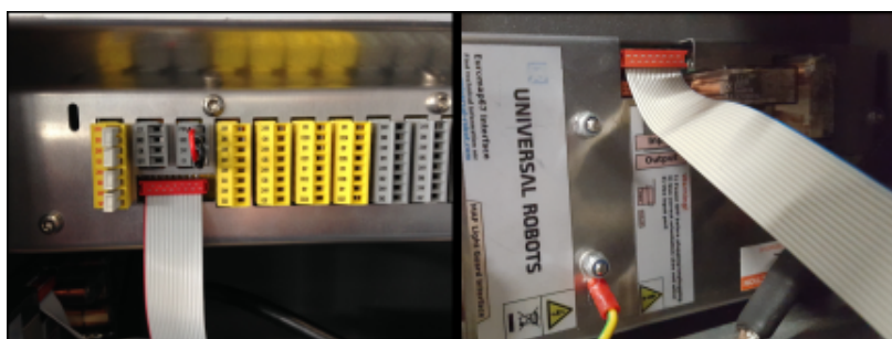
Figura 19.1: Conexão do cabo tipo ribbon
