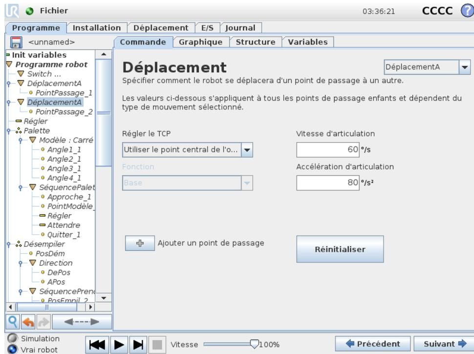
La commande **Déplacement** contrôle le mouvement du robot au cours des points de passage sous-jacents. Les points de passage doivent être sous une commande Déplacement. La commande Déplacement définit l'accélération et la vitesse auxquelles le bras du robot se déplace entre ces points de passage.
