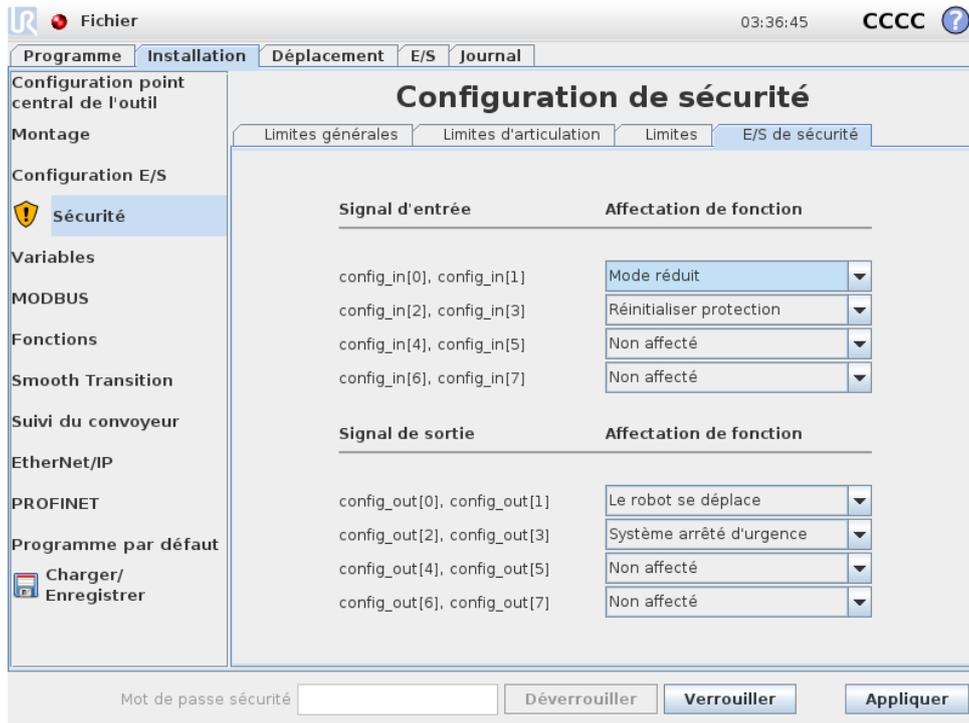
Cet écran définit les *Fonctions de sécurité* pour les entrées et les sorties (E/S) configurables. Les E/S sont réparties entre les entrées et les sorties, et sont associées de façon à ce que chaque fonction fournisse une E/S de catégorie<sup>2</sup> 3 et PLd.
