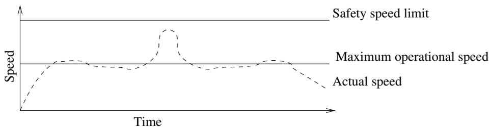
FIGURE 10.1 – Exemple de tolérance de sécurité.
