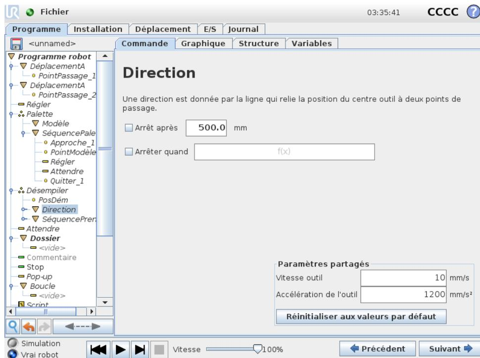
La direction est donnée par deux positions et calculée comme la différence de position entre le point central de l'outil à la première position et celui à la deuxième position.
