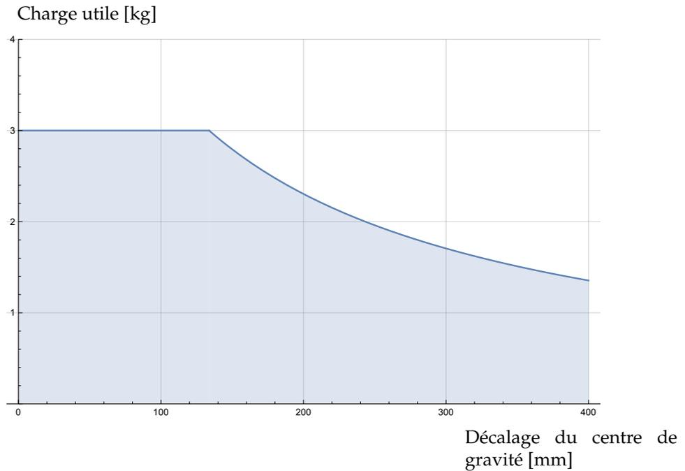
FIGURE 4.3 – La relation entre la charge utile maximum autorisée et le décalage du centre de gravité.
