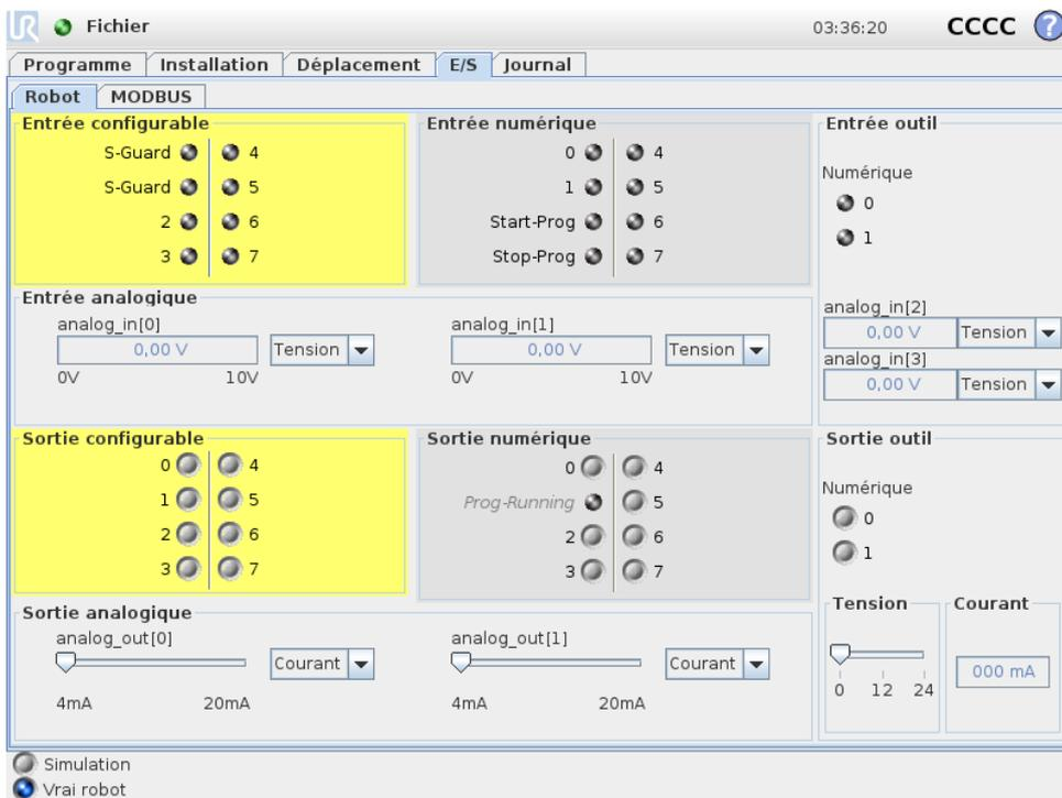
Cet écran vous permet toujours de surveiller et de régler en direct les signaux d’E/S à partir du/vers le boîtier contrôleur du robot. L’écran affiche l’état actuel de l’E/S, y compris au cours de l’exécution du programme. En cas de modification quelconque au cours de l’exécution du programme, celui s’arrête. À l’arrêt du programme, tous les signaux de sortie conservent leur état. L’écran n’est actualisé qu’à 10Hz, ce qui fait qu’un signal très rapide pourrait ne pas s’afficher correctement.
