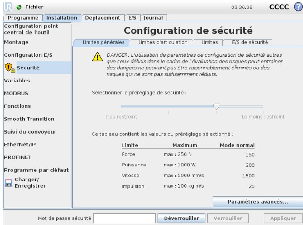
Les paramètres de sécurité se composent d'un certain nombre de valeurs limites utilisées pour restreindre les mouvements du bras du robot, et de paramètres de fonction de sécurité pour les entrées et les sorties configurables. Ils sont définis dans les sous-onglets suivants de l'écran de sécurité :
