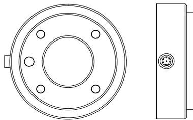
Ce connecteur fournit l'alimentation et les signaux de commande des capteurs et mécanismes de préhension utilisés sur un outil robotique spécifique. Les câbles industriels suivants conviennent :
