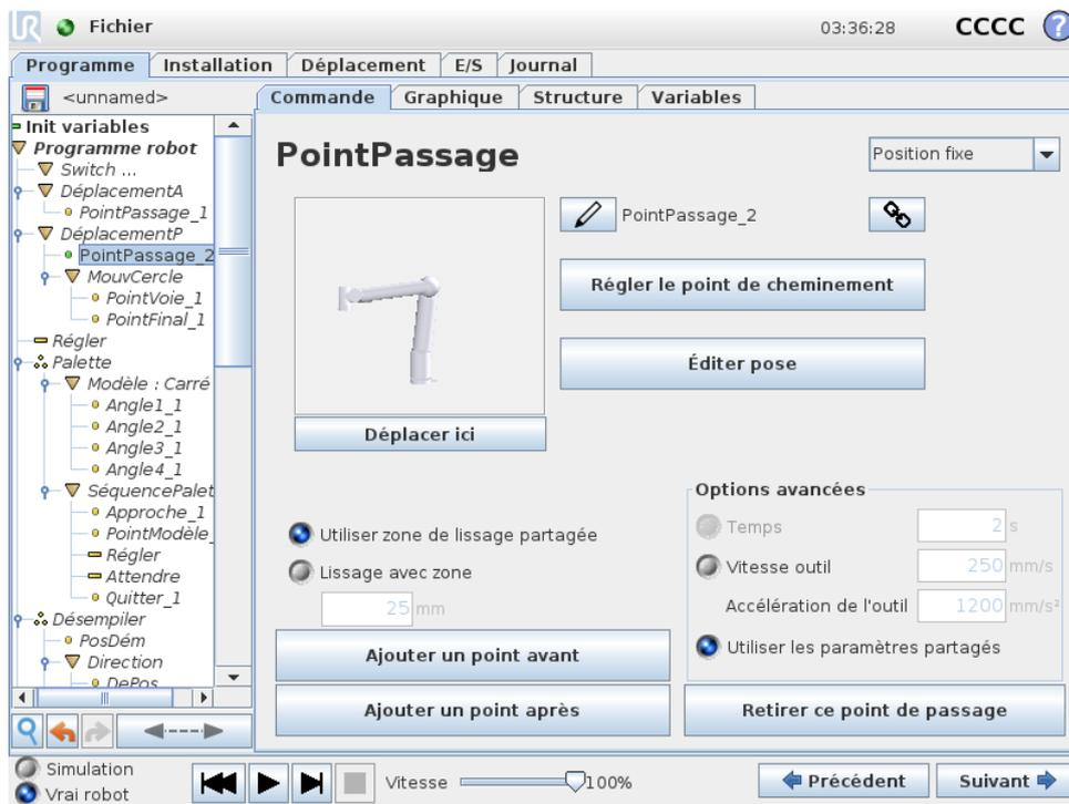
Un point sur la trajectoire du robot. Les points de passage sont la partie la plus centrale d'un programme de robot qui indiquent au bras du robot où se trouver. Un point de passage à position fixe est donné en déplaçant physiquement le bras du robot vers cette position.
