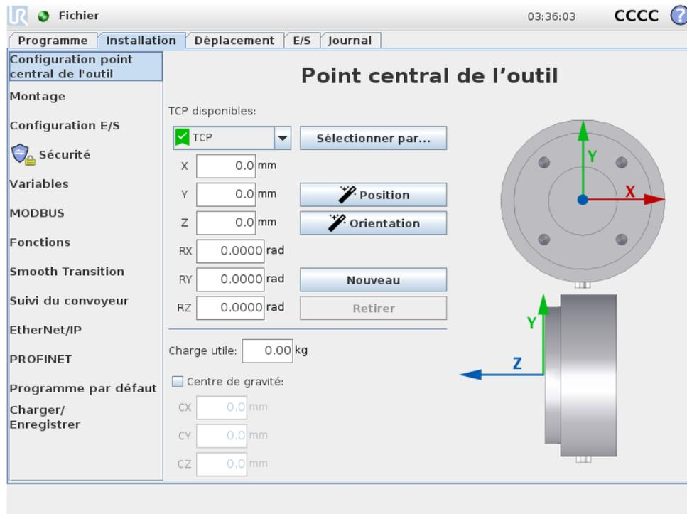
Un **Point central de l'outil** (TCP) est un point de l'outil du robot. Le TCP est défini et nommé dans l'Onglet Installation de l'écran **Configuration pour le Point central de l'outil** (affiché ci-dessus). Chaque TCP contient une translation et une rotation par rapport au centre de la bride de sortie d'outil.
