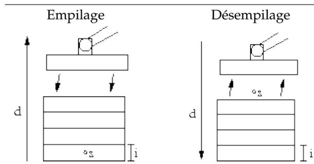
En programmant une opération de recherche pour travailler sur une pile, il faut définir le point de démarrage,  $s$ , la direction d'empilage,  $d$  et l'épaisseur des articles dans la pile,  $i$ .
