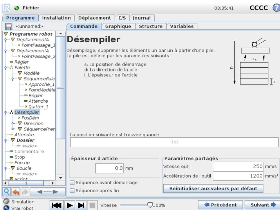
En désempilant, le bras du robot se déplace de la position de démarrage dans la direction donnée afin de rechercher l'article suivant. La condition à l'écran détermine à quel moment l'élément suivant sera atteint. Une fois la condition satisfaite, le robot mémorise la position et effectue la séquence spéciale. La fois suivante, le robot démarre la recherche à partir de la position mémorisée, incrémentée par l'épaisseur de l'article le long de la direction.
