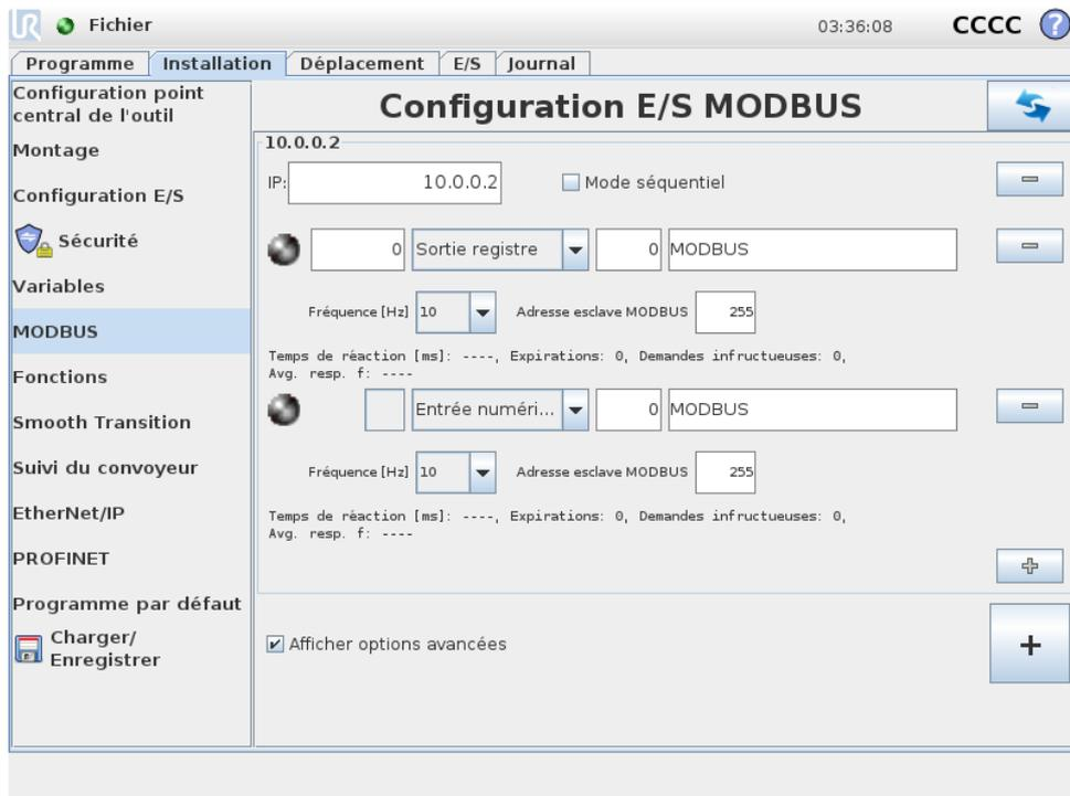
Ici, les signaux client (maître) E/S MODBUS peuvent être réglés. Les connexions aux serveurs MODBUS (ou esclaves) sur les adresses IP spécifiées peuvent être créées avec des signaux d'entrée/sortie (registres ou numériques). Chaque signal a un nom unique pour être utilisé dans les programmes.
