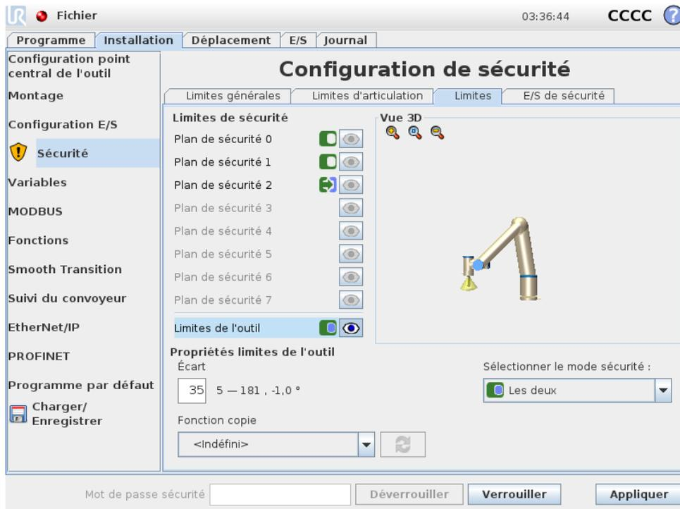
Le panneau **Propriétés** de la limite de l'outil au bas de l'onglet définit une limite sur l'orientation de l'outil du robot constituée d'une orientation d'outil désirée et d'une valeur pour l'écart maximum autorisé à partir de cette orientation.
