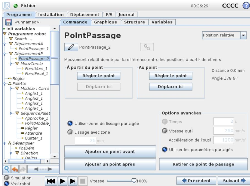
Un point de passage avec la position donnée par rapport à la position précédente du bras du robot, comme par exemple deux centimètres vers la gauche. La position relative est définie comme la différence entre les deux positions données (gauche par rapport à droite).
