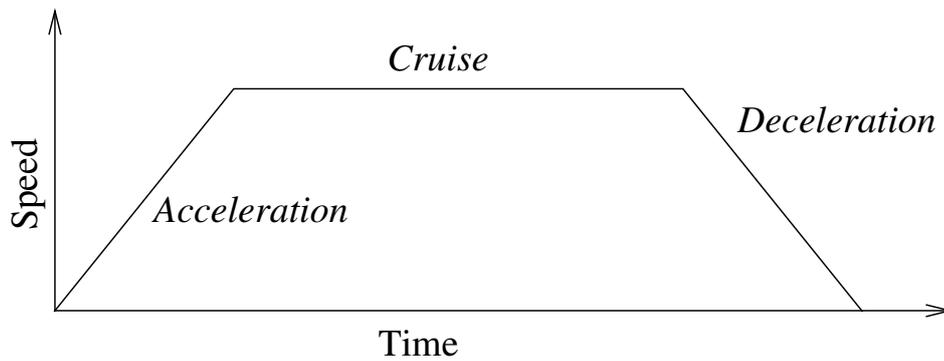
FIGURE 14.1 – Profil de vitesse d'un mouvement. La courbe est divisée en trois segments : *accélération*, *croisière* et *décélération*. Le niveau de la phase *croisière* est donné par le réglage de la vitesse du mouvement, tandis que la pente des phases *accélération* et *décélération* est donnée par le paramètre d'accélération.
