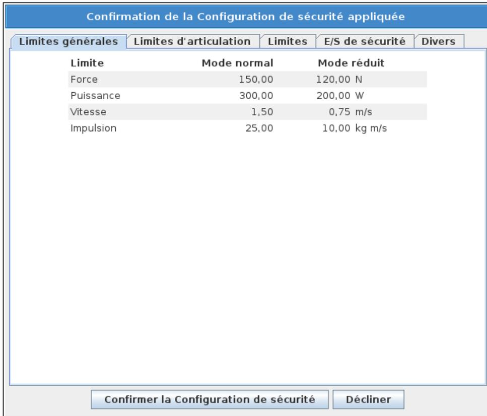
En outre, dès la confirmation, les modifications sont enregistrées automatiquement dans le cadre de l'installation actuelle du robot. Voir 13.5 pour plus d'informations sur l'enregistrement de l'installation du robot.
