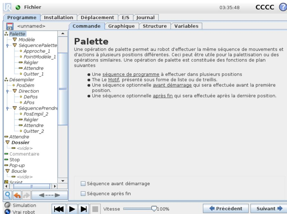
Une opération de palette peut effectuer une séquence de mouvements dans un ensemble d'endroits donné en tant que modèle, (voir 14.23). À chacune des positions du modèle, la séquence de mouvements sera effectuée par rapport à la position du modèle.
