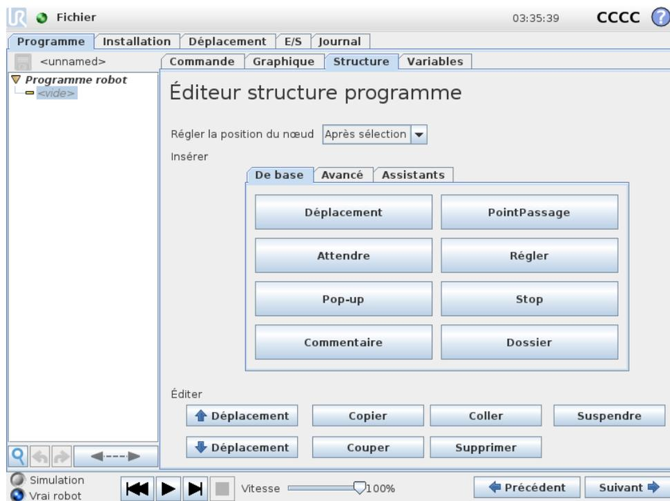
L'onglet Structure du programme permet d'insérer, de déplacer, de copier et de retirer les différents types de commandes.
