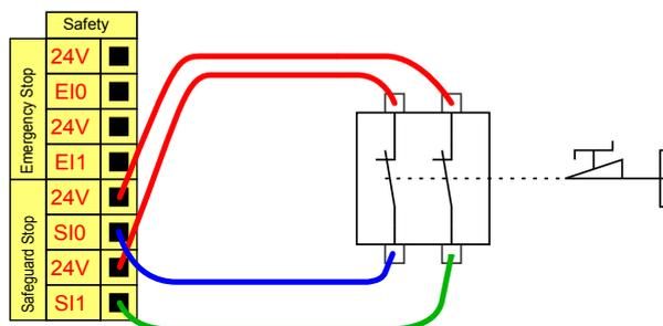
Cette configuration est uniquement destinée à une application où l'opérateur ne peut pas passer la porte et la fermer derrière lui. Les E/S configurables peuvent être utilisées pour configurer un bouton de réinitialisation à l'extérieur de la porte, afin de réactiver le mouvement du robot. Un autre exemple dans lequel la reprise automatique peut être adéquate est lors de l'utilisation d'un tapis de sécurité ou d'un scanner laser de sécurité, voir ci-dessous.
