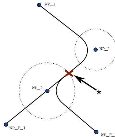
FIGURE 14.5 – WP\_I est le point de cheminement initial et il existe deux points de cheminement finaux potentiels WP\_F\_1 et WP\_F\_2, selon une expression conditionnelle. L’expression conditionnelle si est évaluée lorsque le bras du robot entre le second mélange (\*).
