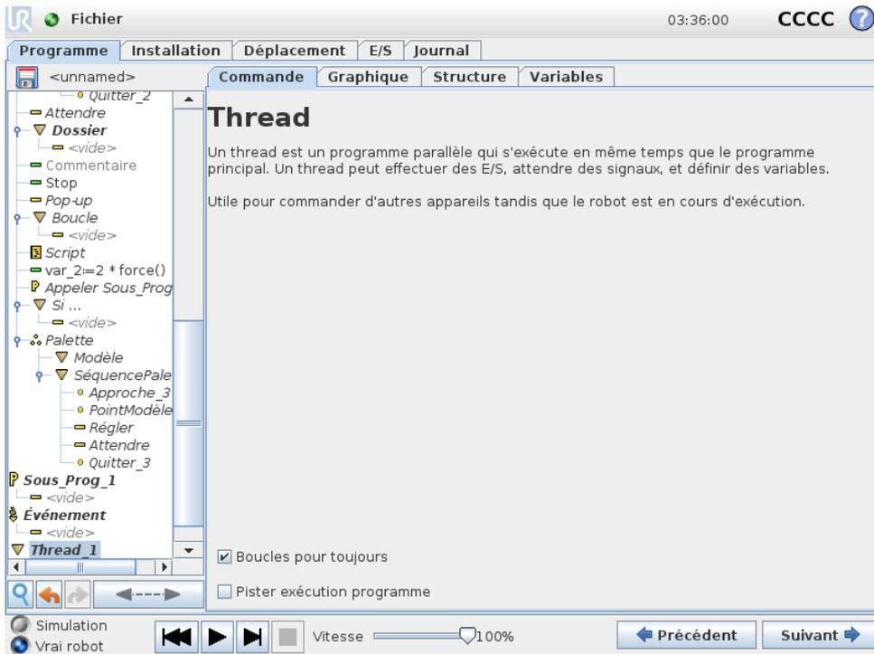
Un thread est un processus parallèle au programme du robot. Un thread peut être utilisé pour contrôler une machine externe indépendamment du bras robotique. Un thread peut communiquer avec le programme du robot avec des variables et signaux de sortie.
