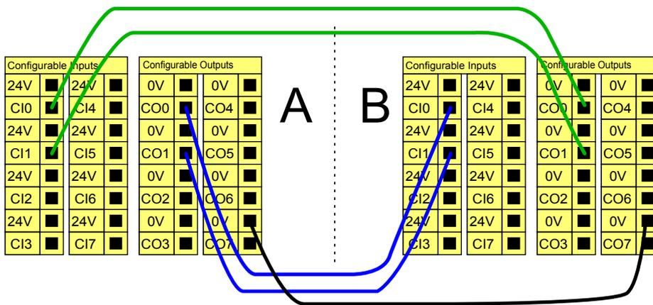
Si plus de deux robots UR ou autres machines doivent être connectés, un automate programmable de sécurité est nécessaire pour commander les signaux d'arrêt d'urgence.
