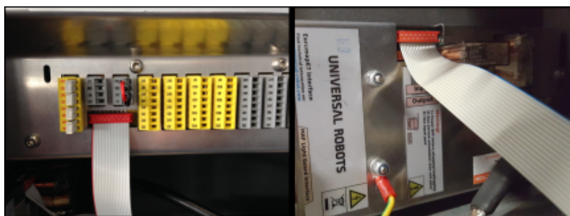
Figura 19.1: Conexão do cabo tipo ribbon
