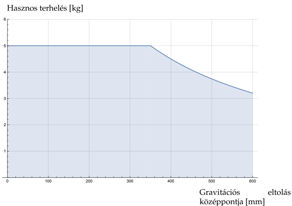
Slika 4.3: A maximálisan megengedett hasznos teher és a gravitációs eltolás középpontja közötti kapcsolat.
