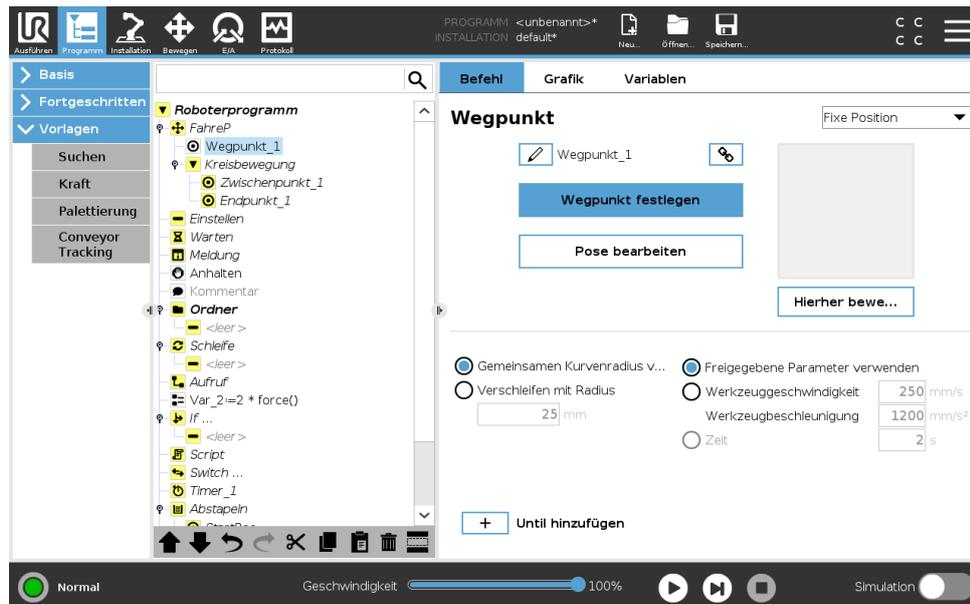
Ein Punkt auf der Bahn des Roboters. Wegpunkte sind der wichtigste Faktor eines Roboterprogramms, da sie die Positionen des Roboterarms bestimmen. Ein Wegpunkt mit einer fixen Position wird angelernt, indem der Roboterarm physisch in die entsprechende Position bewegt wird.
