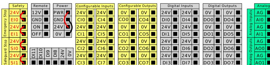
Hinweis: Ebenso können Sie den horizontalen Digitaleingangsblock DI8-DI11 (siehe Abbildung unten) als Quadratur-Encoder für Fließband-Tracking (siehe 5.4.1) für diese Art des Eingangs verwenden.
