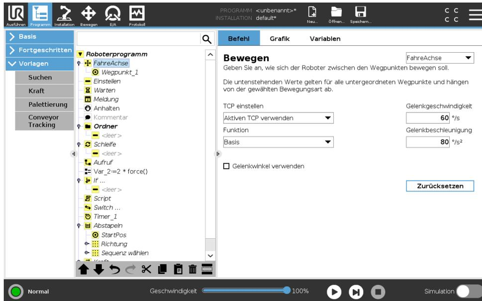
Der **Move**-Befehl steuert die Roboterbewegung durch die zugrunde liegenden Wegpunkte. Wegpunkte müssen unter einem Move-Befehl vorhanden sein. Der Befehl „Move“ definiert die Beschleunigung und die Geschwindigkeit, mit der sich der Roboterarm zwischen diesen Wegpunkten bewegen wird.
