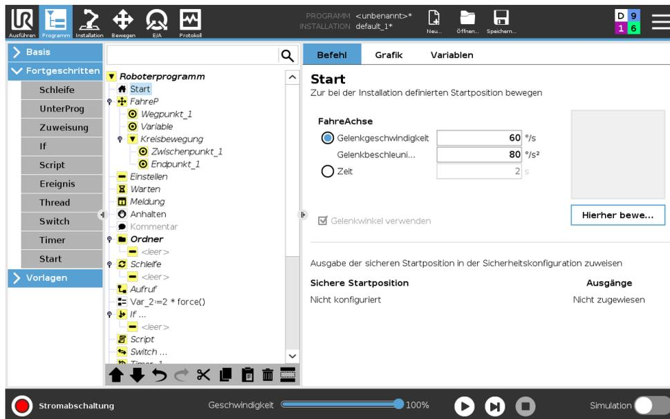
Der Home-Knoten verwendet Gelenkwinkeln zum Bewegen des Roboters an eine zuvor festgelegte Position. Wenn der Home-Knoten als „Sichere Home-Position“ definiert ist, wird er als Home (Sicherheit) in der Programmstruktur angezeigt. Wenn die Home-Position nicht mit „Sicherheit“ definiert ist, ist der Knoten nicht definiert.
