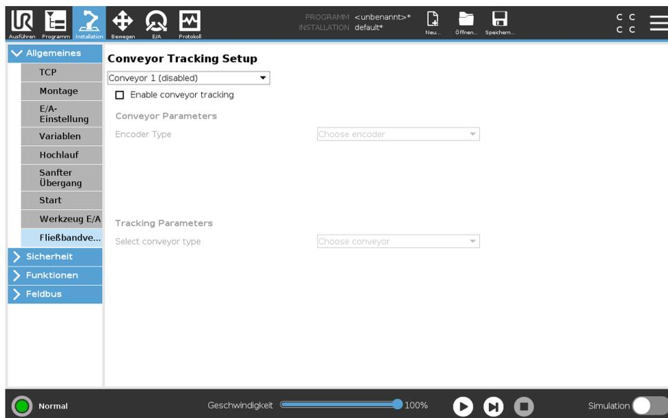
Der Programmknoten „Fließband-Tracking“ steht im Tab Programm unter dem Tab Vorlagen zur Verfügung. Alle Bewegungen unter diesem Knoten sind beim Fließband-Tracking erlaubt, stehen aber im Verhältnis zu der Fließbandbewegung. Übergänge sind beim Beenden des Fließband-Trackings nicht erlaubt, sodass der Roboter vollständig vor der nächsten Bewegung stoppt.
