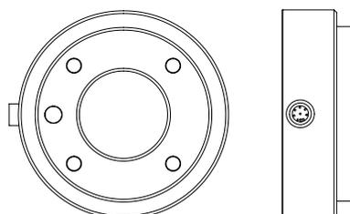
Dieser Stecker liefert Leistungs- und Steuerungssignale für Greifer und Sensoren, die mit einem bestimmten Roboterwerkzeug verwendet werden. Ein geeignetes Industriekabel ist das hier genannte
