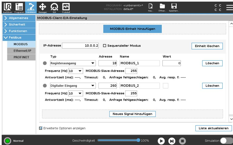
Hier können die Signale des MODBUS-Client (Master) eingestellt werden. Verbindungen zu MODBUS-Servern (oder Slaves) auf angegebenen IP-Adressen können mit Eingangs-/Ausgangssignalen (Register oder digital) erstellt werden. Jedes Signal hat einen einmaligen Namen, damit es in Programmen verwendet werden kann.
