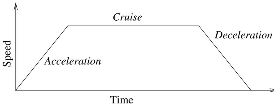
Abbildung 15.1: Geschwindigkeitsprofil für eine Bewegung. Die Kurve wird in drei Segmente unterteilt: *Beschleunigung*, *konstante Bewegung* und *Verlangsamung*. Die Ebene der *konstanten Bewegung* wird durch die Geschwindigkeitseinstellung der Bewegung vorgegeben, während der Anstieg und Abfall der Phasen in *Beschleunigung* und *Verlangsamung* durch den Beschleunigungsparameter vorgegeben wird.
