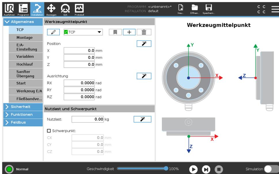
Ein **Tool Center Point (TCP)** ist ein Punkt auf dem Roboterwerkzeug. Der TCP ist im Installations-Tab im Bildschirm **Einrichtung für den Werkzeugmittelpunkt** definiert und benannt (oben abgebildet). Jeder TCP enthält eine Verschiebung und Drehung bezogen auf die Mitte des Werkzeugausgangsflanschs
