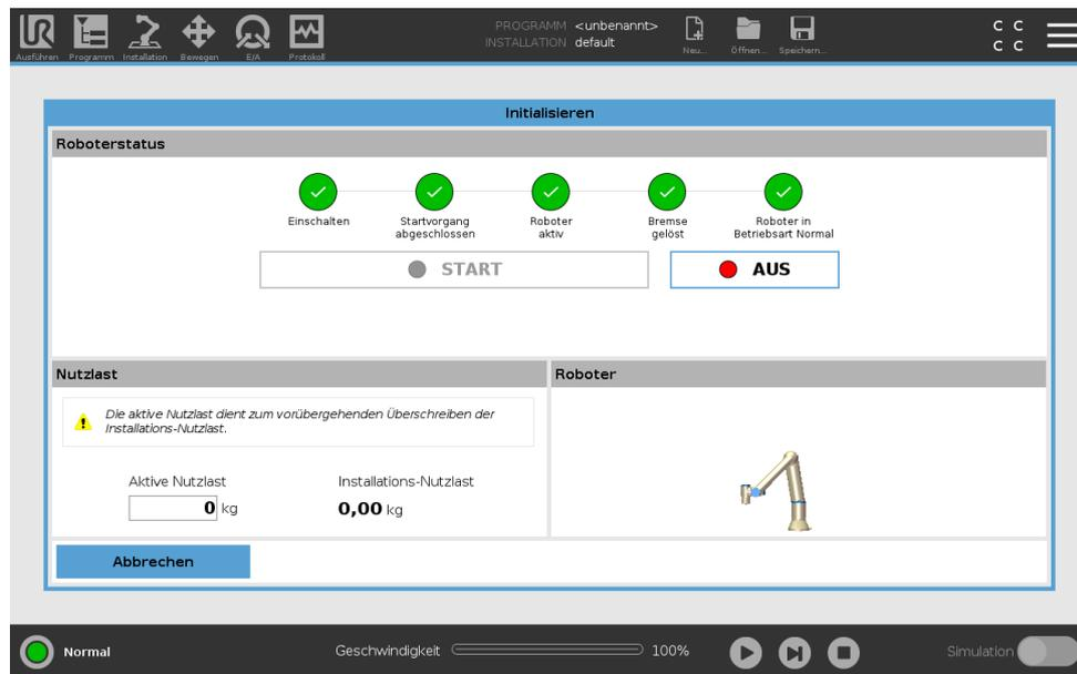
Hinweis: Bei der Inbetriebsetzung des Roboterarms sind durch das Lösen der Gelenkbremsen Geräusche zu hören und es finden leichte Bewegungen statt.
