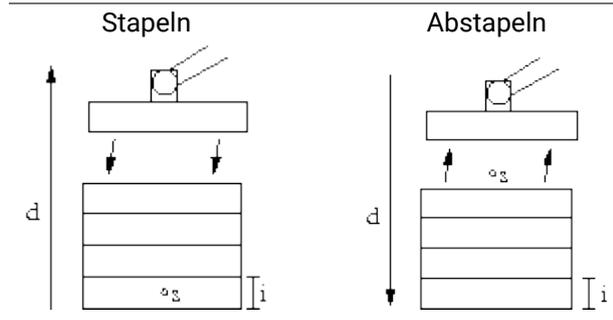
Bei der Programmierung eines Stapelvorgangs ist der Ausgangspunkt  $s$ , die Stapelrichtung  $d$  und die Stärke der Artikel auf dem Stapel  $i$  zu definieren.
