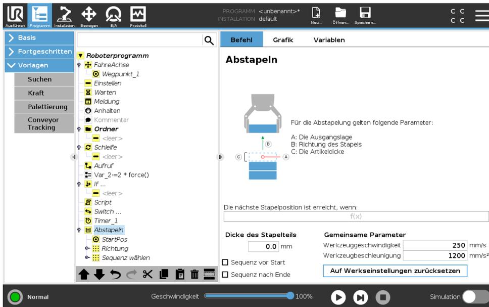
Beim Abstapeln bewegt sich der Roboterarm von der Ausgangsposition in die angegebene Richtung, um nach dem nächsten Element zu suchen. Die Voraussetzung auf dem Bildschirm bestimmt, wann das nächste Element erreicht wird. Wenn die Voraussetzung erfüllt wird, merkt sich der Roboter die Position und führt die spezielle Abfolge aus. Das nächste Mal startet der Roboter die Suche aus dieser Position, erweitert um die Stärke des Elements in der Stapelrichtung.
