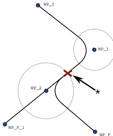
Abbildung 15.5: WP\_I ist der Ausgangswegpunkt und es gibt zwei mögliche endgültige Wegpunkte WP\_F\_1 und WP\_F\_2, je nach einem bedingten Ausdruck (if ... then). Die Bedingung if wird ausgewertet, sobald der Roboterarm den zweiten Übergang (\*) erreicht.
