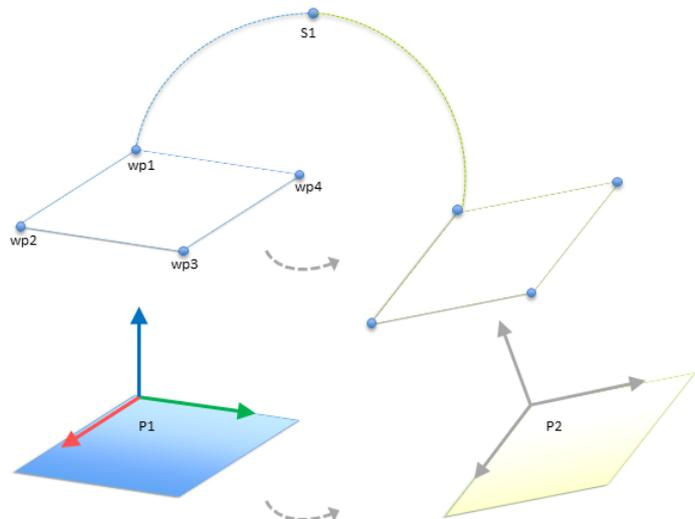
Abbildung 16.7: Umschalten von einer Ebenenfunktion zu einer anderen
