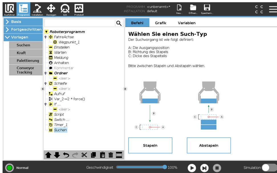
Beim Stapeln bewegt sich der Roboterarm in die Ausgangsposition und dann in die *Gegenrichtung*, um die nächste Stapelposition zu suchen. Wenn gefunden, merkt sich der Roboter die Position und führt die spezielle Abfolge aus. Das nächste Mal startet der Roboter die Suche aus dieser Position, erweitert um die Stärke des Elements in der Stapelrichtung. Das Stapeln ist beendet, wenn die Stapelhöhe eine bestimmte Anzahl erreicht hat oder der Sensor ein Signal gibt.
