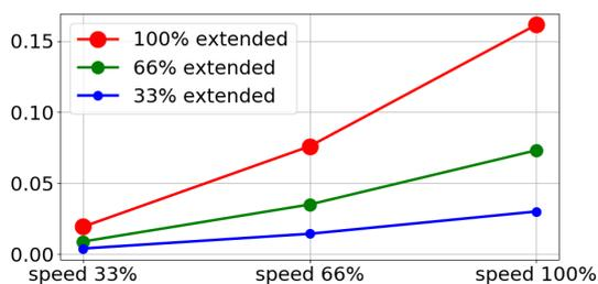
(a) Nachlaufweg in Meter für 33% maximale Nutzlast
