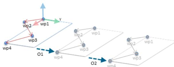
Abbildung 16.6: Anwenden einer Verschiebung bei der Ebenenfunktion
