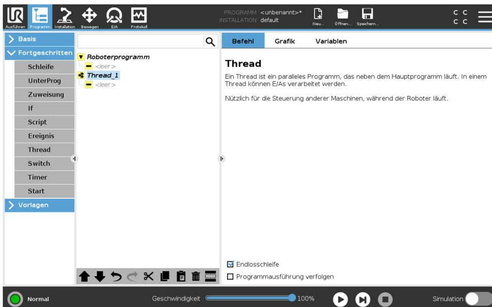
Ein Thread ist ein paralleler Prozess zum Roboterprogramm. Ein Thread kann zur Steuerung einer externen Maschine, unabhängig vom Roboterarm, eingesetzt werden. Ein Thread kann mithilfe von Variablen und Ausgangssignalen mit dem Roboterprogramm kommunizieren.
