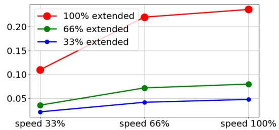
(b) Stoppdauer in Sekunden für 66% maximale Nutzlast
