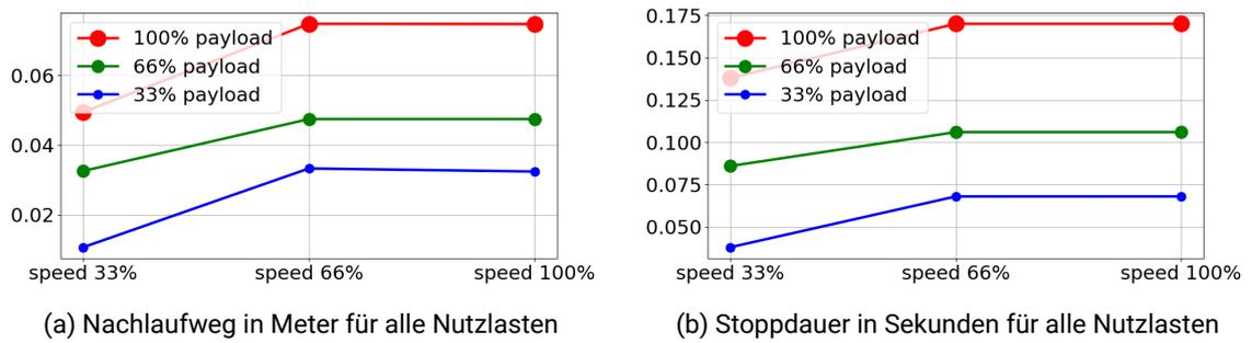
Abbildung A.5: Nachlaufweg und Stoppdauer für Gelenk 2 (ELLBOGEN)
