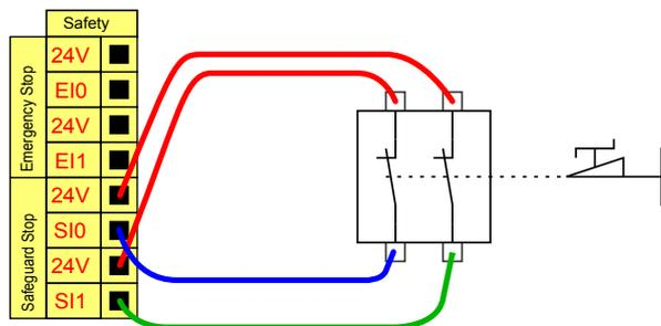
Diese Konfiguration trifft nur auf Anwendungen zu, bei denen der Betreiber die Tür nicht passieren und hinter sich schließen kann. Mit dem konfigurierbaren E/A wird eine Reset-Taste vor der Tür eingerichtet, um den Roboterbetrieb wiederaufzunehmen.
