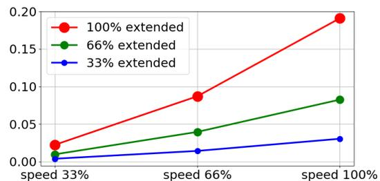
(b) Nachlaufweg in Meter für 66% maximale Nutzlast
