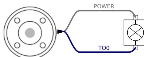
Es wird empfohlen, eine Schutzdiode für induktive Lasten zu verwenden (s. unten).
