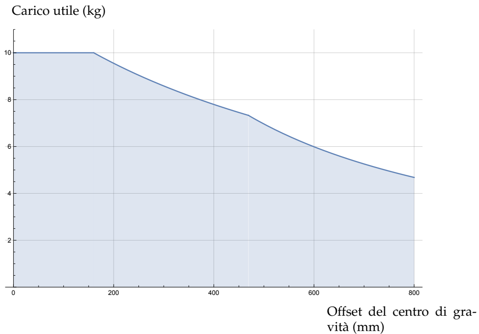
Figura 4.3: Rapporto fra il carico utile massimo consentito e l'offset del centro di gravità.
