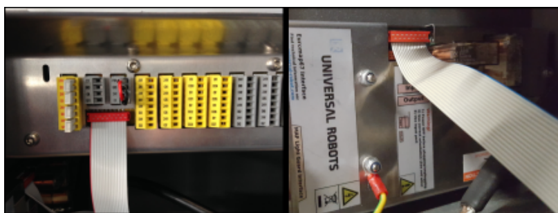
Figura 19.1: Conexión del cable plano
