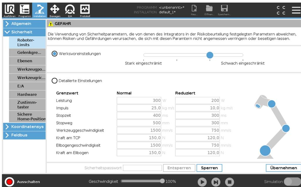
2. Unter Detaillierte Einstellungen können Sie Grenzwerte für die Funktionsweise des Roboters festlegen und die damit verbundene Toleranz im Auge behalten.
