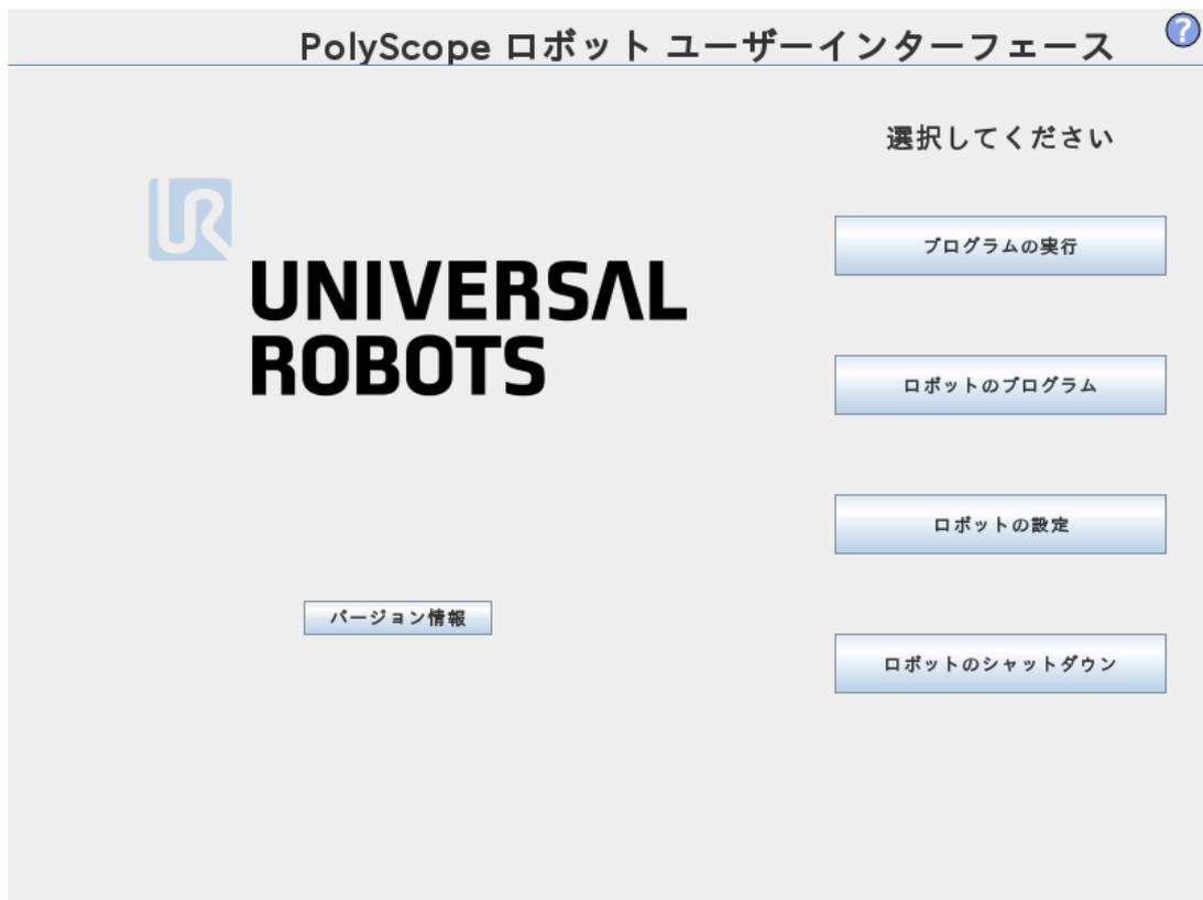
[プログラム実行]、[ロボットのプログラム]、または [ロボット 設置設定の構成] を選択します。
