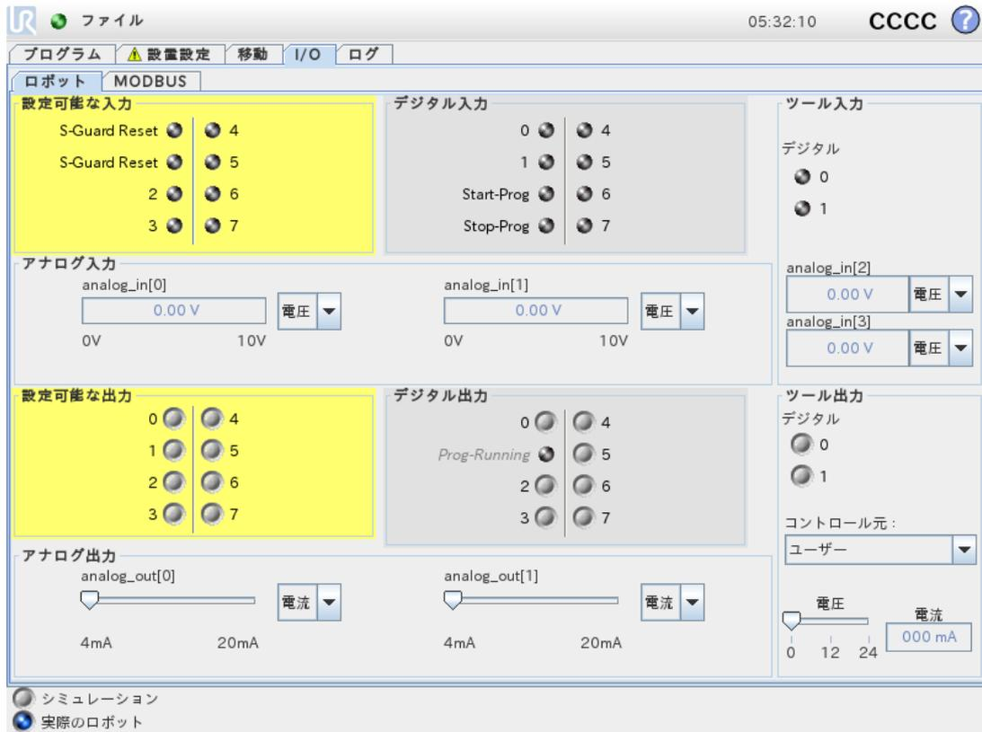
この画面では、ロボットのコントロールボックスが送受信する生のI/O信号をモニターおよび設定できます。画面は、プログラム実行中も含めて、I/Oの現在の状態を表示します。プログラム実行中に何かが変わると、プログラムは停止します。プログラム停止時には、すべての出力信号はその状態を保持します。画面は、10Hzの周期で更新されるため、高速の信号は適切に表示されない場合があります。
