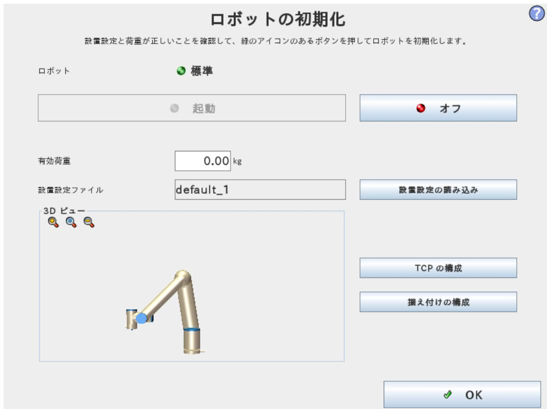
注：ロボットアームの起動では、ジョイントのブレーキが解除されるため、若干の音と移動が伴います。
