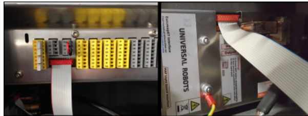
18.1: Připojení plochého kabelu
