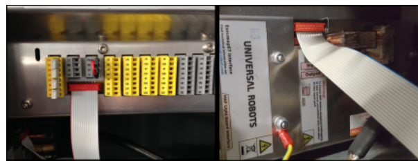
18.1: Conexão do cabo tipo ribbon
