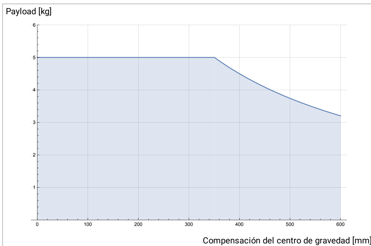
6.3: La relación entre la carga máxima permitida y la compensación del centro de gravedad.
