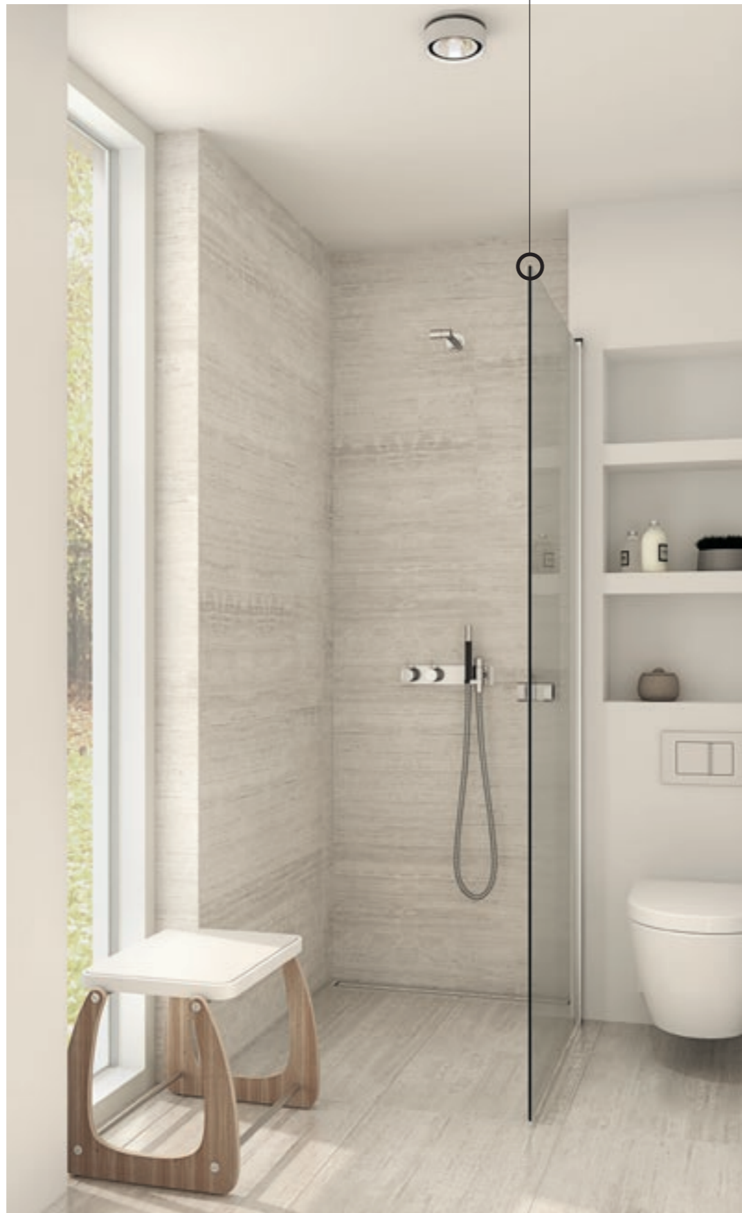
Die kleine Nischenwand verbirgt die Einbau-Zisterne und gibt Platz für eine praktische, platzsparende Duschlösung
