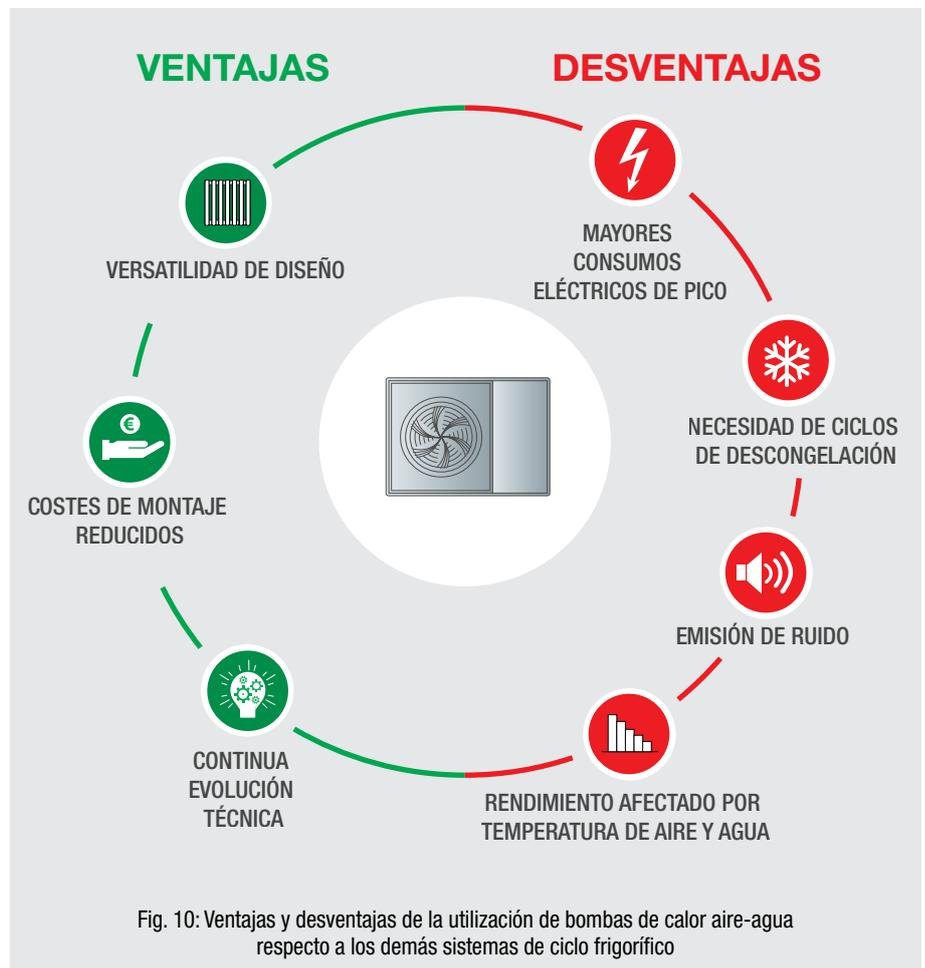
Fig. 10: Ventajas y desventajas de la utilización de bombas de calor aire-agua respecto a los demás sistemas de ciclo frigorífico
