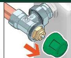
Per effettuare la prerogolazione della portata, posizionare l'apposita ghiera sagomata. Il riferimento della posizione di taratura è definito dall'orientamento della superficie laterale piana (1) dell'asta di comando.
