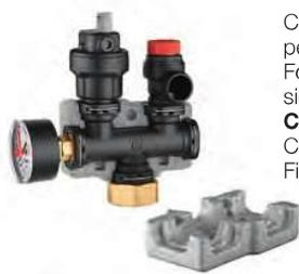
Collettore portastrumenti in tecnopolimero per impianti di riscaldamento. Fornito di valvola sfogo aria, valvola di sicurezza in tecnopolimero e manometro.
