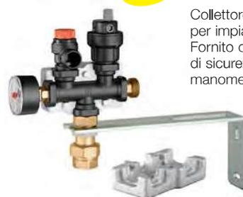
Collettore portastrumenti in tecnopolimero per impianti di riscaldamento. Fornito di valvola sfogo aria, valvola di sicurezza in tecnopolimero, manometro, rubinetto automatico di intercettazione per vasi d'espansione e staffe di fissaggio.
