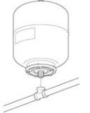
La membrana recambiable o a globo aguanta mejor las 'grandes' fluctuaciones de presión en el circuito. Por ese motivo es el mejor sistema 'sin duda' para la aplicación de sistemas de bombeo y presurización.
