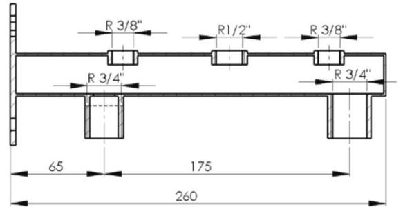
El soporte para set de medición facilita la instalación de vasos de expansión de 15-50 l con 1" y rosca de conexión. Un soporte puede contener todos los accesorios necesarios donde hay espacio para una válvula de purga, una válvula de seguridad, un manómetro, un tubo de conexión y un vaso de expansión. La parte de apoyo del soporte está atornillada a la pared y los componentes se instalan posteriormente en el soporte.
