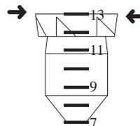
**¡Atención!** Para regular el caudalímetro, utilice exclusivamente una llave fija de 9 mm.
