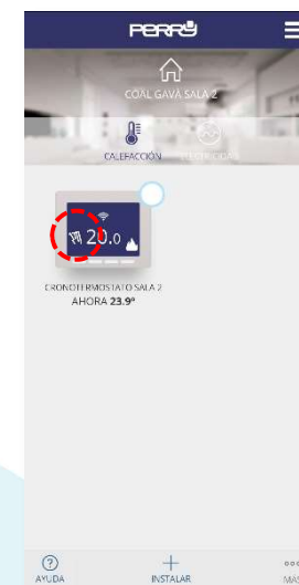
Aparecerá el símbolo MANUAL en el termostato
