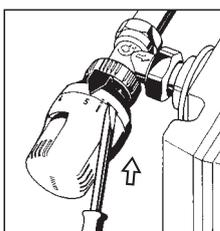
**1.** Gire el mando a la posición completamente abierta (Pos. 5). Utilizando un destornillador, suelte la virola empujándola hacia el cuerpo de la válvula hasta el tope.
