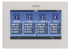
Vista general de las temperaturas de regulación
